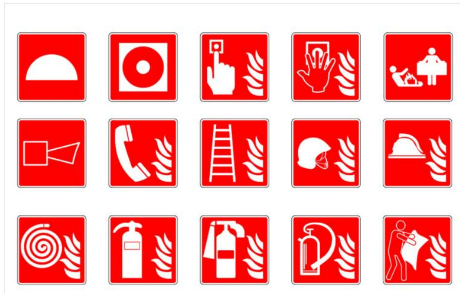
Figura 1: Señalización de los medios de protección contra incendios
