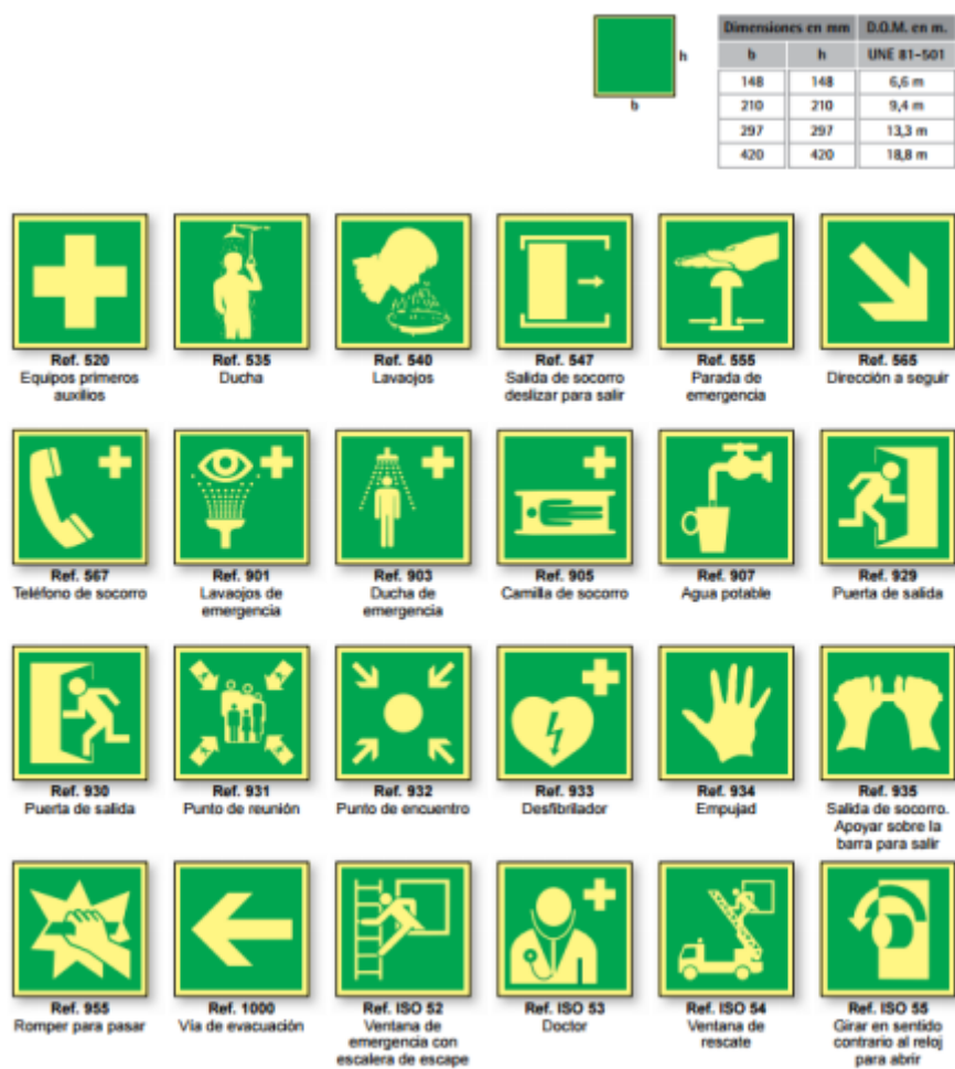
Figura 7. Señales de salvamento.
