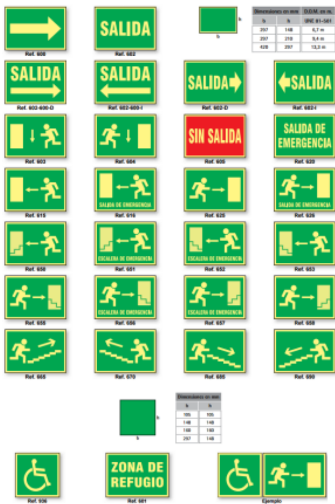
Figura 6. Señales de evacuación 3.
