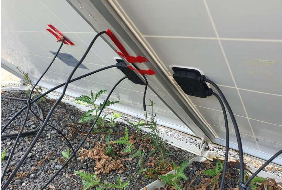
Figura 24: Detalle de la posición de las sondas de temperatura ambiente y de superficie de panel.
