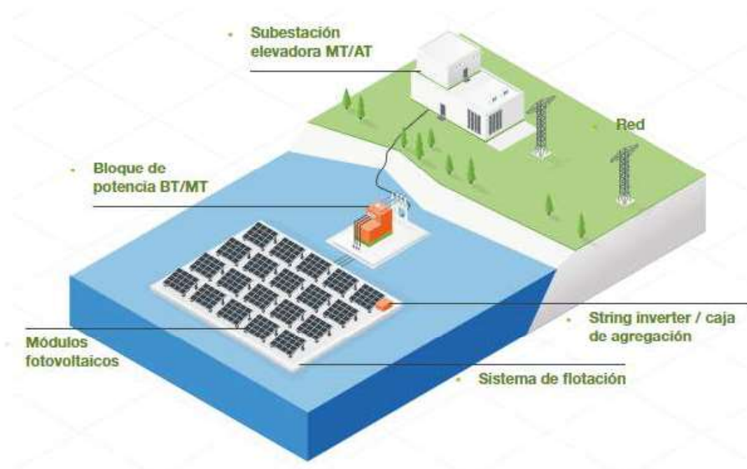
Figura 5: Esquema de instalación fotovoltaica flotante. Fuente: [8]
