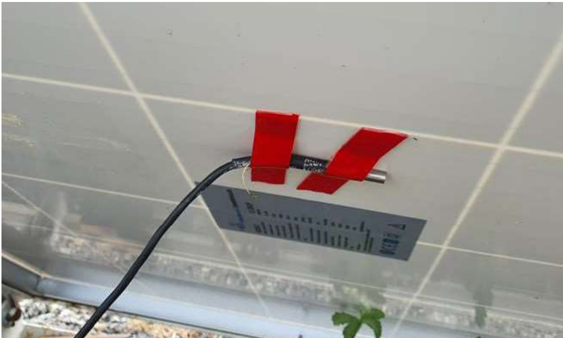
Figura 25: Detalle de la sonda de temperatura de superficie de panel.
