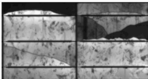
Figura 11: Cracks perpendiculares a los bus bars (Fuente: IEC TS 60904 - 13:2018).
