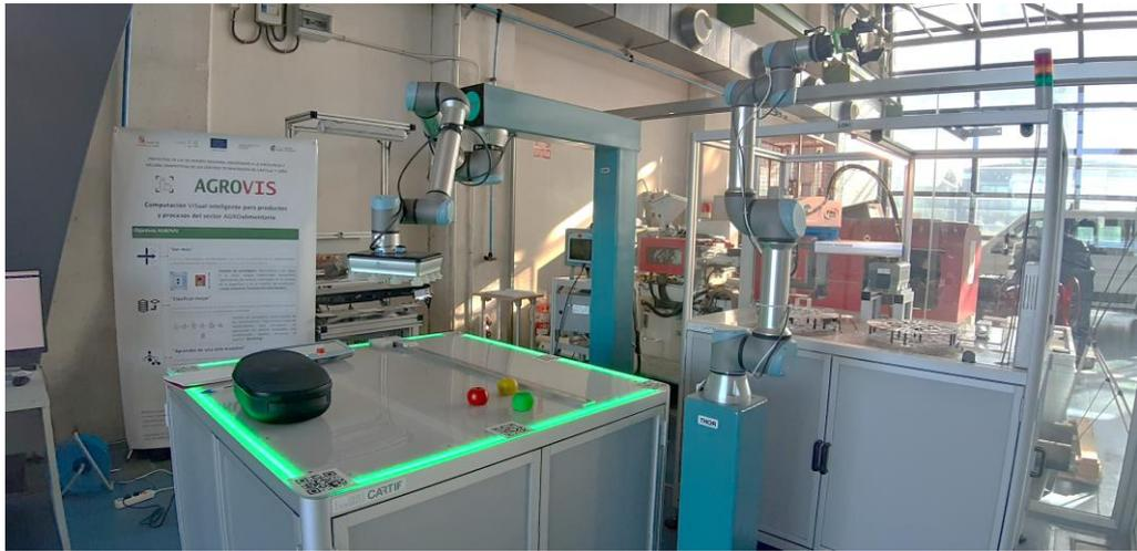
*Ilustración 22. Disposición de los cobots en la célula de trabajo*
