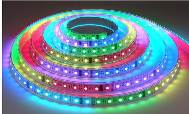
Ilustración 23. Ejemplo de luces LED RGB 5050 SMD encendidas (Fuente: [30])
