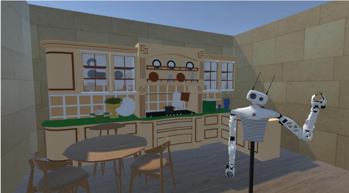
*Figura 6.3. Reachy realizando un saludo que ha sido programado mediante python.*
