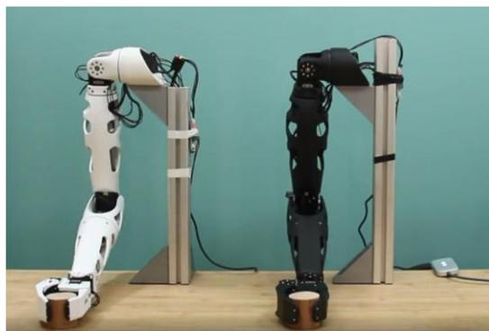
*Figura 3.6. Agarre de objeto mediante los brazos de Reachy y posición de inicio de la trayectoria [8].*
