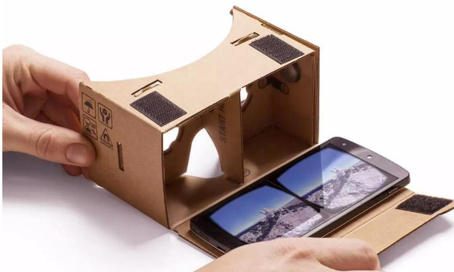
*Figura 4.2. Equipo sencillo de VR compuesto por un smartphone y unas gafas de cartón [12].*
