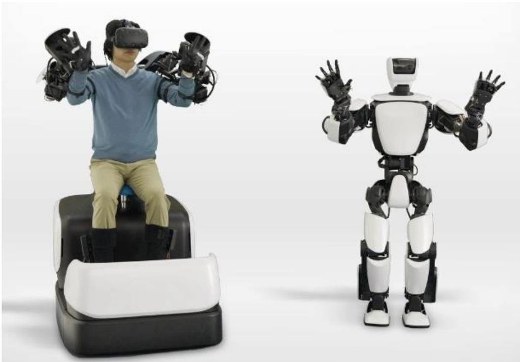
*Figura 2.6. Robot Toyota T-HR3 siendo teleoperado [6].*
