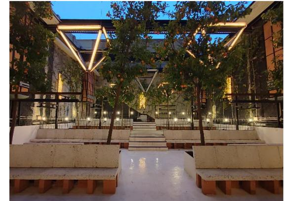
transformarlo en un restaurante, utilizando los materiales obtenidos de la demolición como partes esenciales del local. Las sillas se construyeron con la madera del patio de butacas y los asientos de la “terraza” fueron fabricados con los residuos de la demolición. Las luminarias fueron recuperadas de diferentes parkings y arregladas por la Asociación Norte Joven<sup>19</sup> junto con el equipo de diseño.
