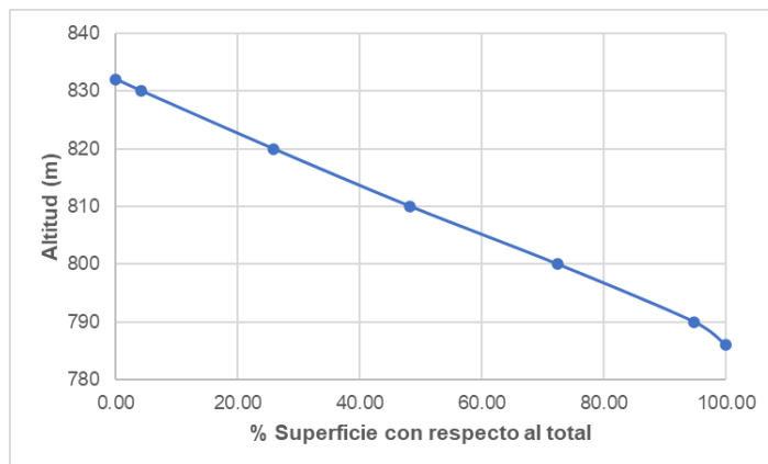
Figura 21: Curva hipsométrica de la subcuena 12
