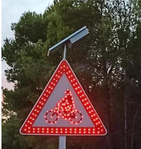
Figura 13. Señal P-22 con leds de alta visibilidad. Fuente: Twitter
