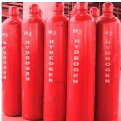
Figura 17: Depósitos tipo I de hidrógeno comprimido. Fuente: [19]
