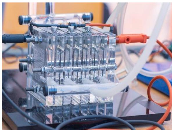
Figura 49: Pila de combustible PEM real. Fuente: [38]
