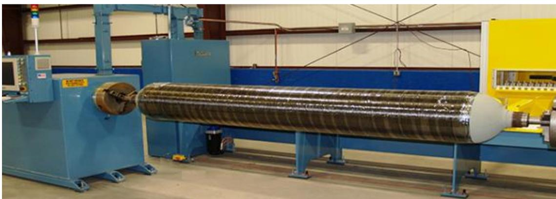
Figura 18: Depósito tipo II de hidrógeno comprimido. Fuente: Online [19]
