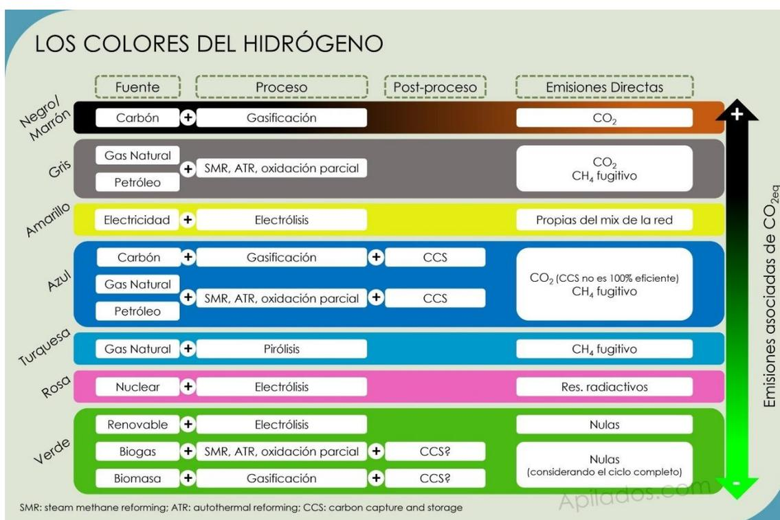
Figura 63: Esquema conceptual de los colores del hidrógeno según sus fuentes, procesos, post-procesos y emisiones. Fuente: [44]
