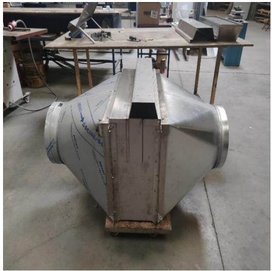
Figura 2: evaporador sin el soporte-estructura
