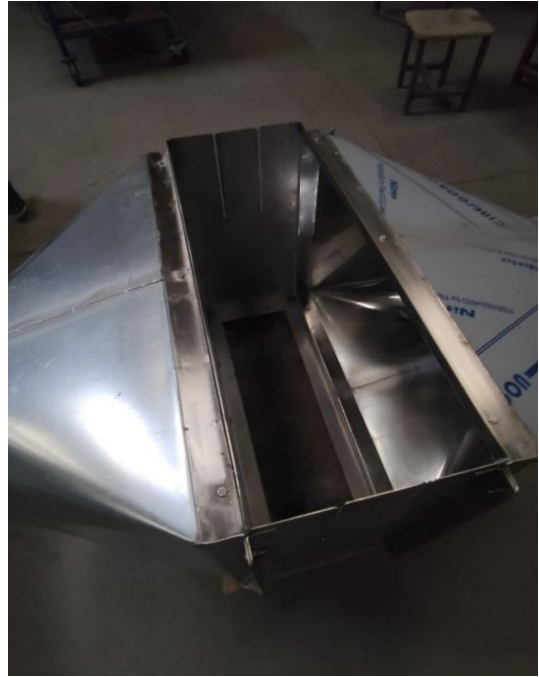
Figura 3: Perspectiva superior del evaporador sin las tapas
