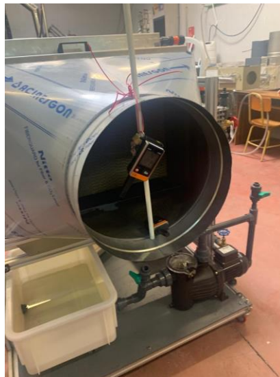
Figura 28: Posición de las sondas a la salida del evaporador
