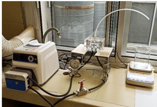
**Figura 4.** Sistema de filtración utilizado para la experimentación.
