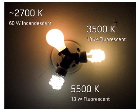
Figura 17: Ejemplo del efecto de la temperatura del color de las fuentes (imagen de dominio público vía Wikipedia).
