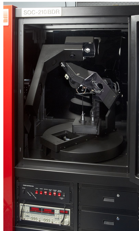
Figura 18: La figura en la parte superior muestra un dispositivo empleado para medir la función BRDF de un material. Se emite un rayo de luz desde todas las direcciones posibles y se mide la cantidad de luz reflejada (imagen propiedad de E. Erin CC BY-SA vía Wikipedia).
