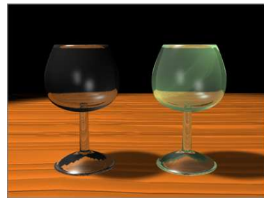
Figura 22: Efecto de la translucencia. El cristal de la derecha tiene translucencia verde (imagen propiedad de Autodesk 3DS).
