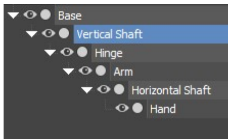
Figura 9. Cadena cinemática de la grúa
