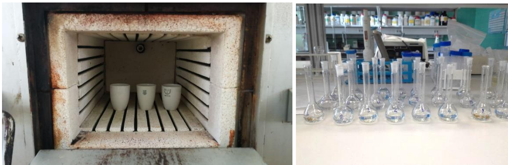
Figura 16 Mufla de calcinación y material preparado para realización de la colorimetría en P_{total} , P_{org} y P_{inorg} .
