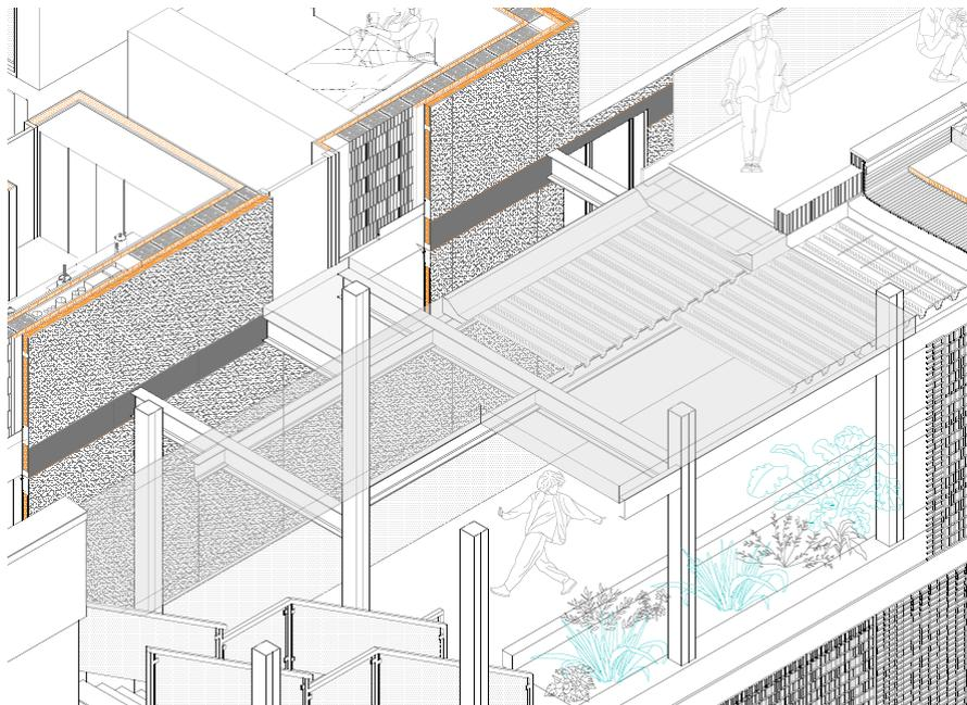
A estos perfiles IPE300 soldados al alma van dos líneas, un IPE200 sobre el que se apoya un forjado de chapa colaborante, y por el otro lado un conjunto de UPN que encierra otro forjado de chapa colaborante, se
