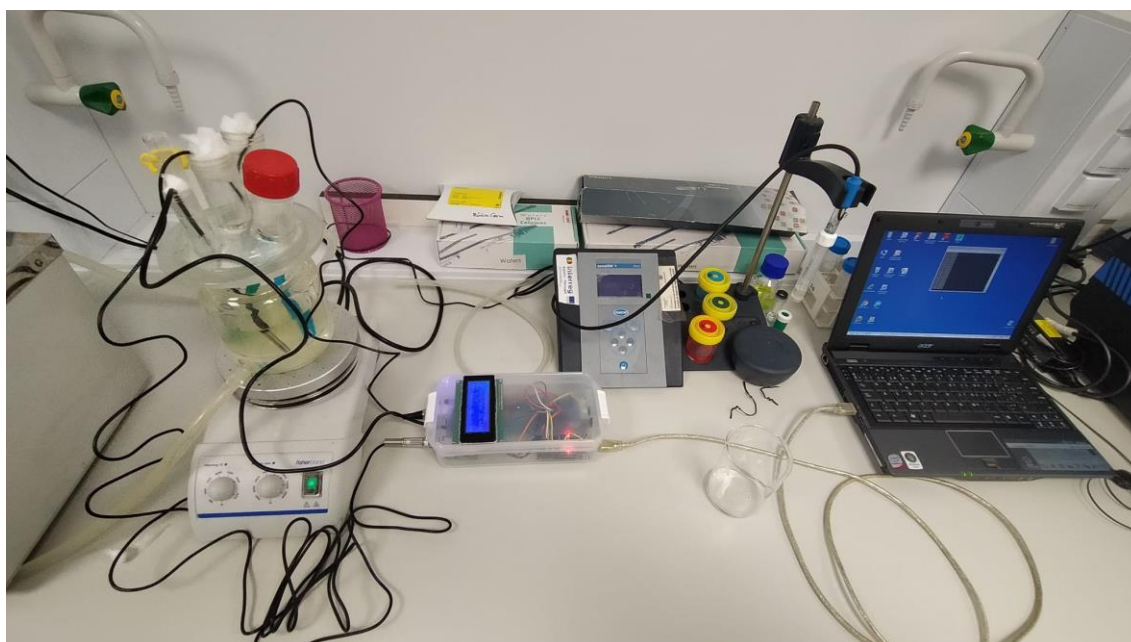
Figura 49. Prueba del dispositivo durante un proceso de fermentación.
