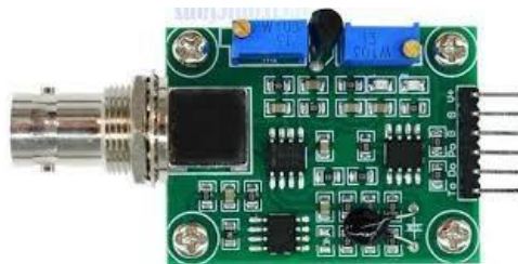
Figura 31. Placa PH-4502C como sensor de pH analógico. [23]
