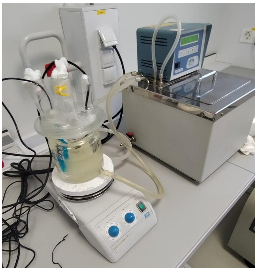
Figura 50. Biorreactor utilizado para el experimento del dispositivo con agitador magnético y calentador.
