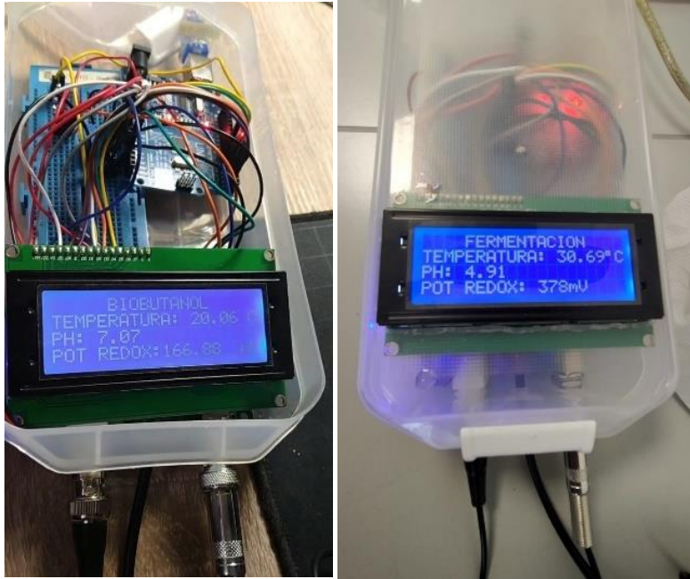
Figura 45. Montaje Arduino UNO y los tres sensores junto con la pantalla LCD con y sin tapa de la caja.
