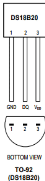
Figura 15. Encapsulado TO-92 (DS18B20).[14] Figura 16. Sonda sensor de temperatura digital DS18B20.[15]
