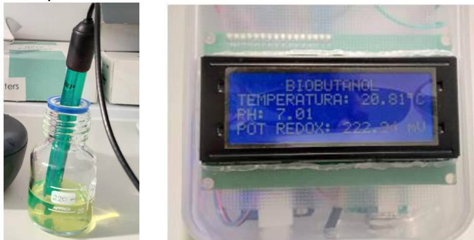
Figura 57. Resultado del dispositivo en la medida de potencial redox en una disolución de 220mV.
