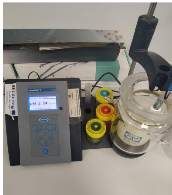
Figura 54. Medida final del pH de la fermentación por el dispositivo y por la sonda del laboratorio.
