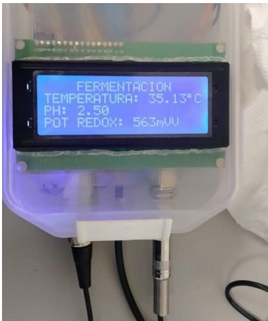
Figura 54. Medida final del pH de la fermentación por el dispositivo y por la sonda del laboratorio.
