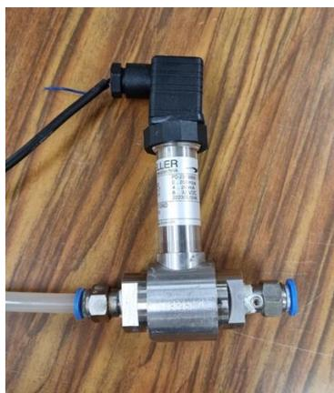
Figura 26. Sensor de presión para medir el nivel del depósito de impulsión.
