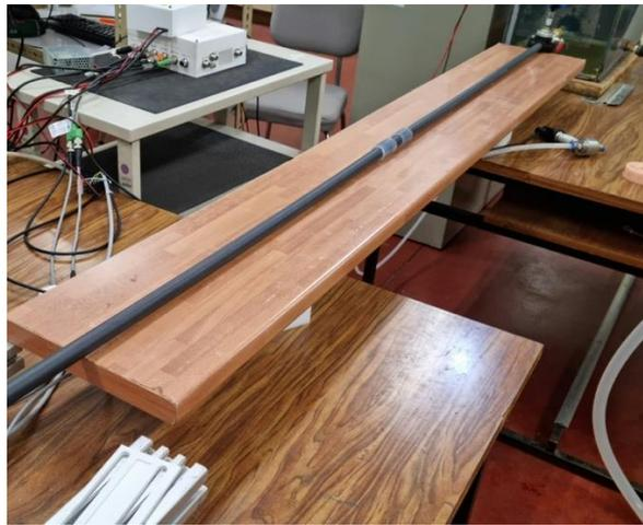
*Figura 22. Tubería rígida de impulsión.*
