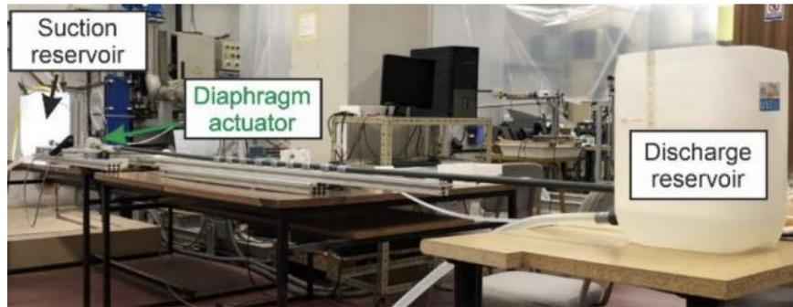
Figura 11. Instalación de bombeo asimétrico de Anatol et al. [1]
