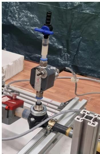
*Figura 27. Manómetro a la entrada del látex.*
