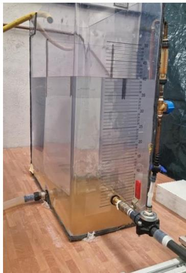
*Figura 19. Depósito de aspiración.*
