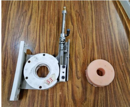
Figura 31. Actuador mecánico (izquierda) y actuador de silicona (derecha).
