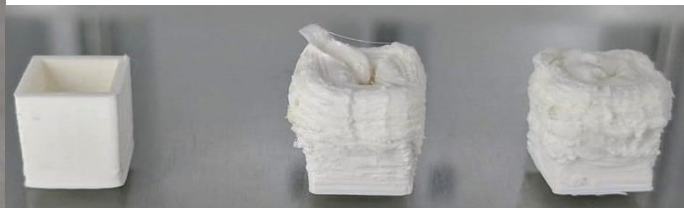
Figura 56: Diferentes tipos de sobre-extrusión. [31]
