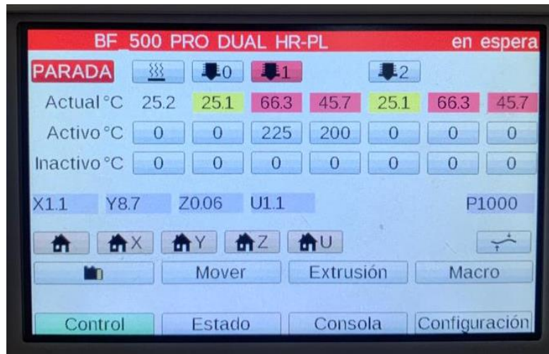
Figura 44: Pantalla táctil implementada en la impresora para el control. [Fuente propia]
