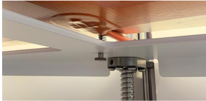
Figura 52: Zona de calentamiento de la base de impresión. [Fuente propia]
