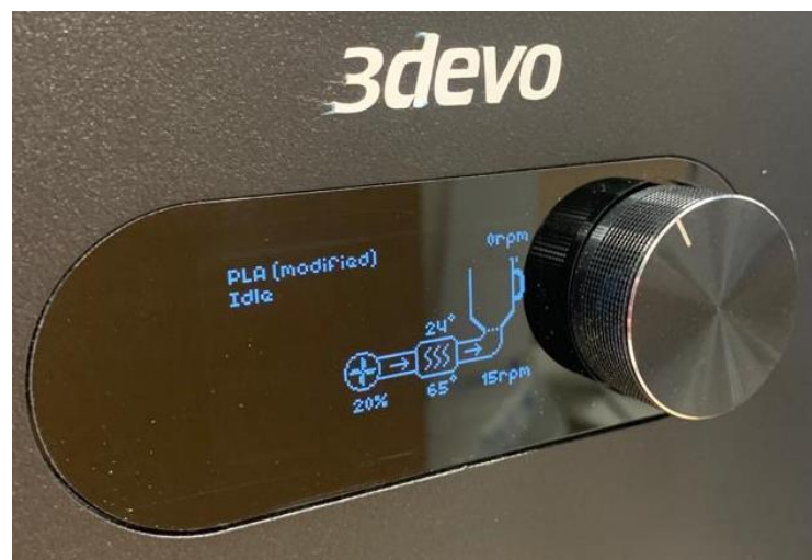
Figura 38: Interfaz montada en la secadora para el control del proceso de secado. [Fuente propia]
