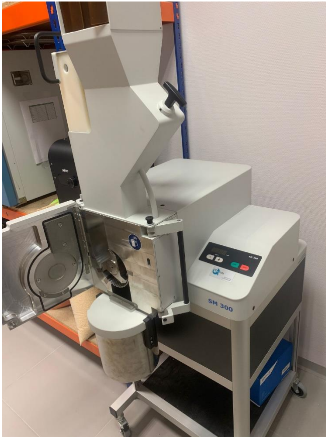
Figura 83: Molino de corte SM 300 para el triturado de material. [Fuente propia]
