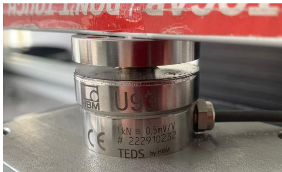
Figura 76: Célula de carga del banco de ensayos. [Fuente propia]
