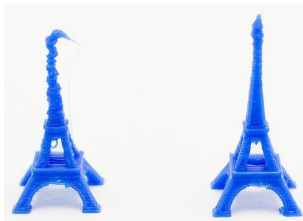
Figura 49: Pieza impresa sin ventilador de capa (izqda) frente a una en la que se ha usado ventilador de capa (dcha). [28]
