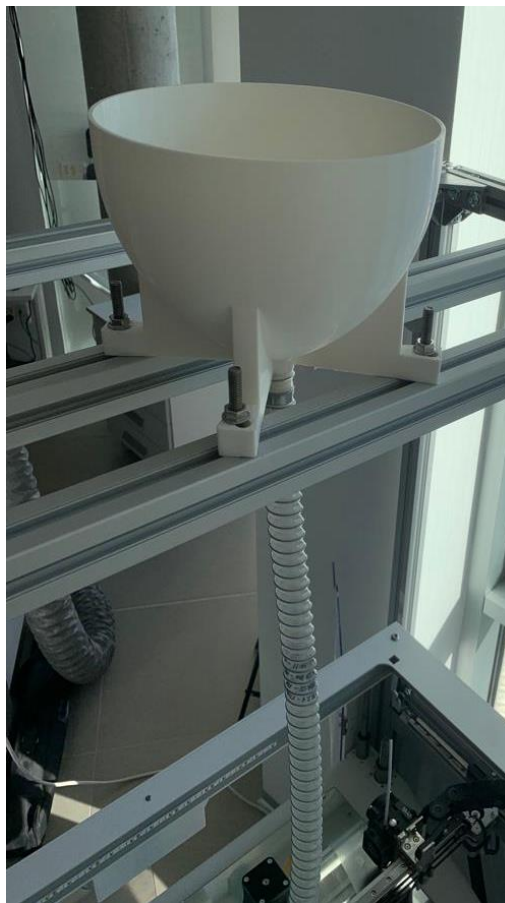
Figura 46: Disposición de la tolva donde descarga el aspirador de pellets el material; Tubo corrugado que dirige el pellet al interior del sistema de extrusión. [Fuente propia]
