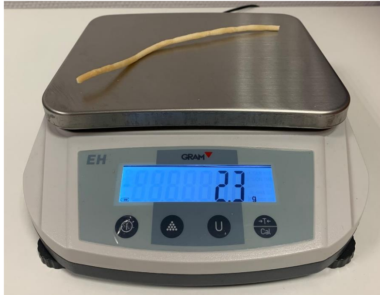
Figura 61: Pesada del cordón de material tras la extrusión en vacío. [Fuente propia]
