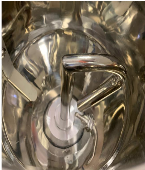
Figura 37: sistema de agitación en el interior de la tolva de secado de material de la empresa 3devo. [Fuente propia]
