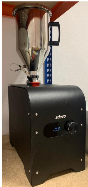
Figura 36: Secador de material en formato pellets Airid Polymer Dryer de la empresa 3devo. [Fuente propia]
