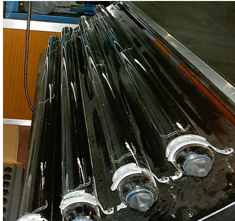
Figura 2.13 Placa solar compuesta por tubos de vacío.
