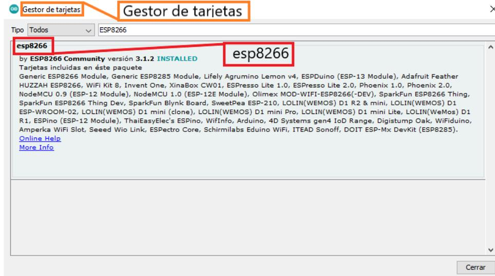
Figura 53. Instalación de la tarjeta con acceso a ESP8266. Fuente: elaboración propia.
