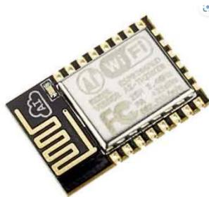
Figura 28. ESP8266 con módulo ESP12/ESP12E. [19]
