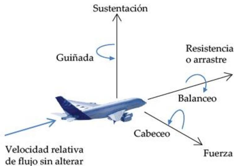
Figura 24. Fuerzas y momentos sobre un cuerpo tridimensional sumergido en un fluido. [6]
