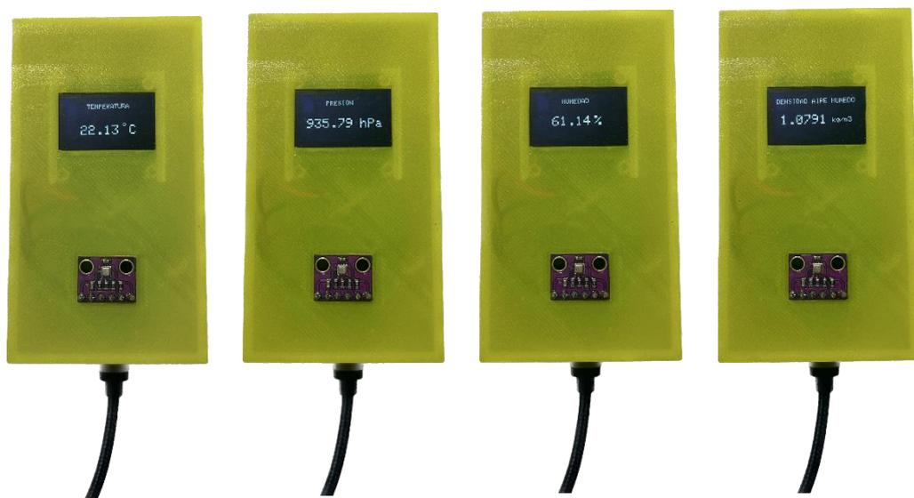
Figura 77. Valores de las 4 magnitudes medidas por el aerómetro mostradas secuencialmente por la pantalla OLED. Fuente: Elaboración propia.
