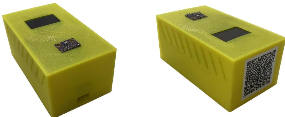
Figura 73. Aerómetro totalmente encapsulado e implementación de código QR. Fuente: elaboración propia.
