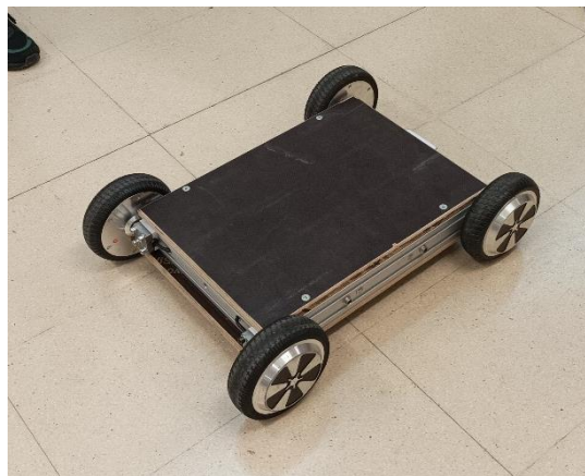
Figura 17. Primer prototipo final, en esta fase el control direccional funcionaba, la función de seguimiento de líneas estaba en proceso.
