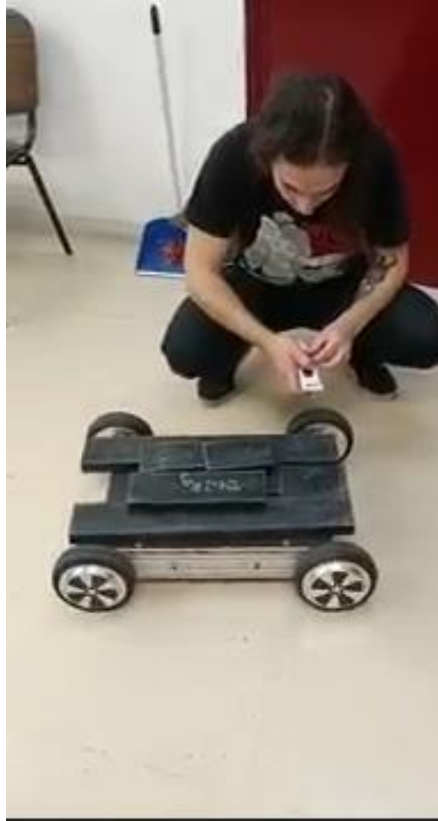
Figura 63. Prueba donde se está sometiendo al prototipo a una carga realizada con pesos.
