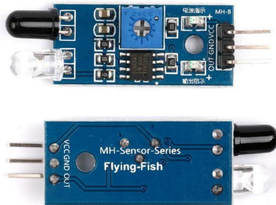
Figura 5. Sensores IR MH-Sensor Series, utilizados en el prototipo LEGO y prototipo final[13]
