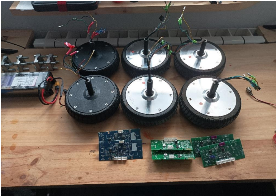
Figura 23. Ruedas con motor extraídas de los HoverBoards.
