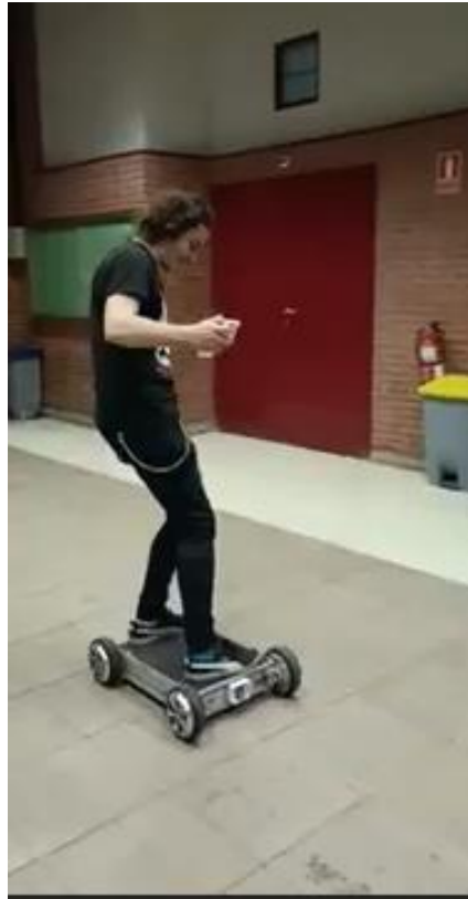
Figura 62. Captura de vídeo donde se aprecia el funcionamiento del prototipo transportando a una persona.
