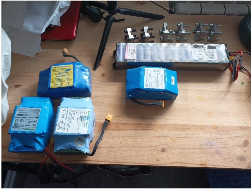
Figura 24. Baterías extraídas de los Hoverboard, así como los "host" metálicos para los bujes de los motores.
