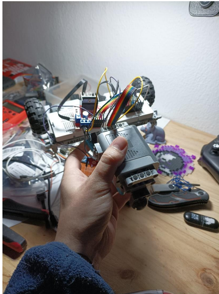
Figura 2: Prototipo sigue líneas con piezas de LEGO
