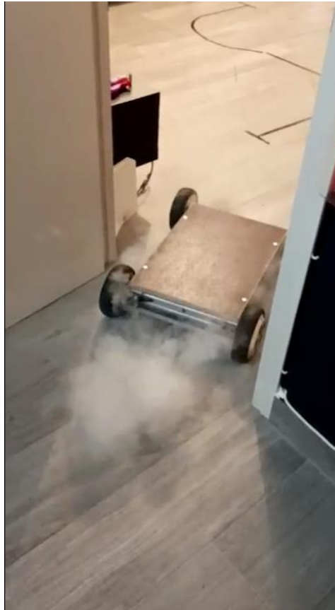
Figura 12. Prototipo final explotando debido a un fallo en una de las baterías.
