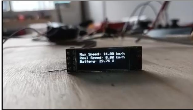
Figura 51. Primera prueba de funcionamiento de la pantalla con su debida comunicación con el receptor.
