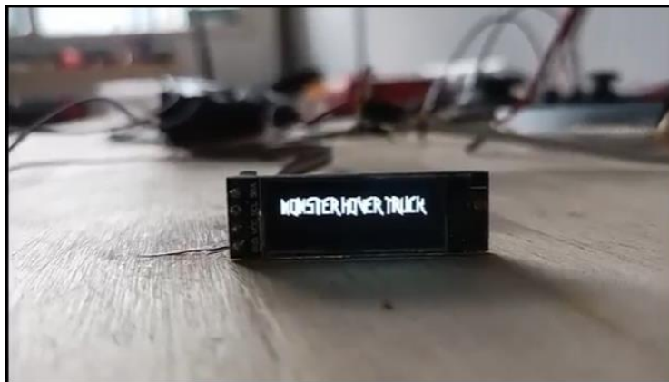
Figura 50. Primera prueba de funcionamiento de la pantalla con su debida comunicación con el receptor.
