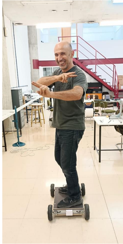
Figura 64. Prueba de carga estática del prototipo final con una persona encima.
