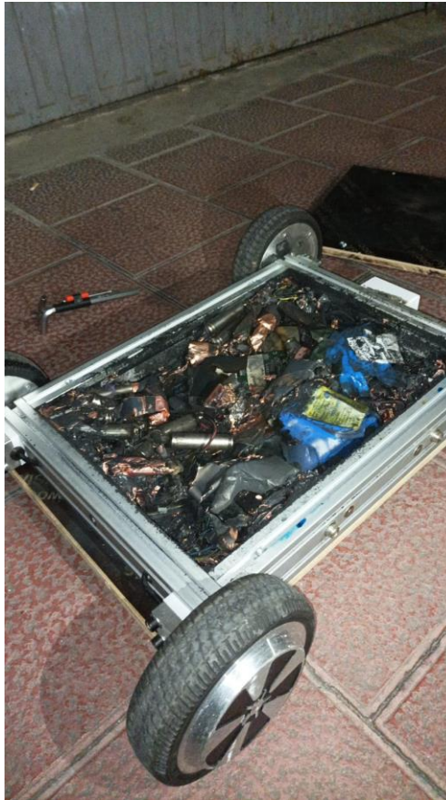
Figura 13. Prototipo final tras el incidente por la explosión de una de las baterías.
