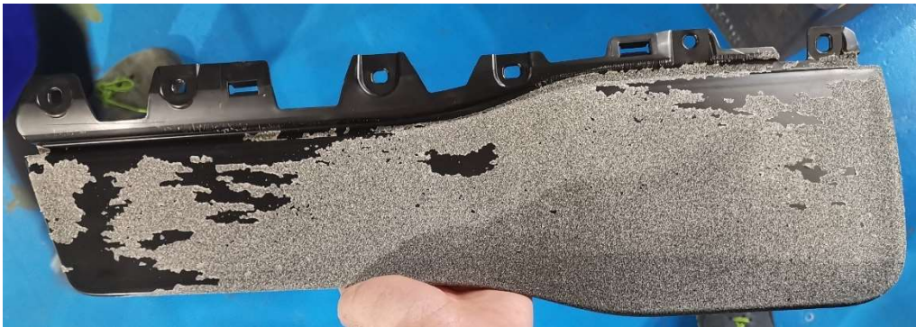
Ilustración 5.24.- Recubrimiento arrancado con efecto cohesivo en un medallón Rg3 para comprobar la correcta adherencia. Fuente: Elaboración propia
