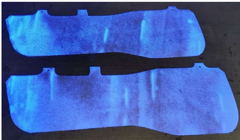
Ilustración 2.6.- Ejemplo de adhesivado incorrecto en formatos de Rg3 Tejido. Fuente: Elaboración propia
