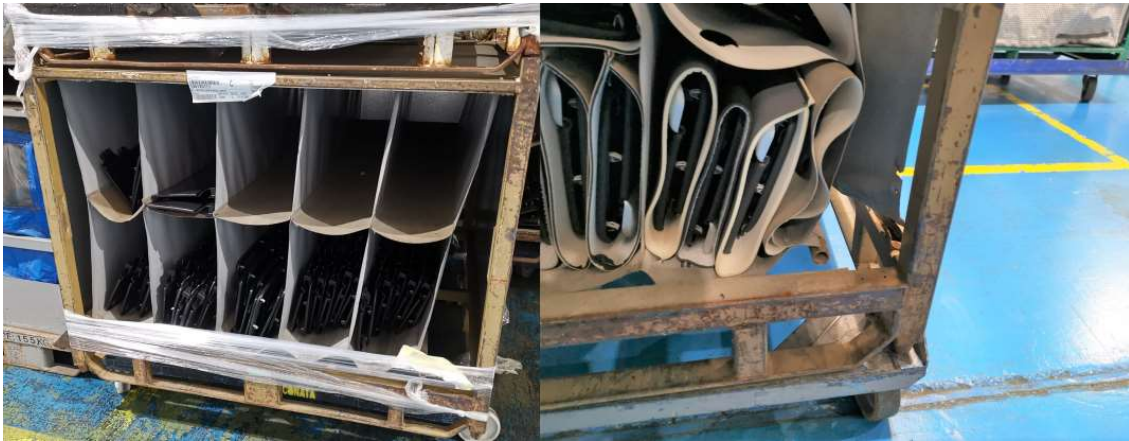
Ilustración 5.40.- Contenedor marrón y problemática de piezas aplastadas por el desencaje de la guía de posición. Fuente: Elaboración propia
