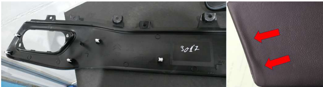
Ilustración 5.19.- Inserto Rg1 con exceso de tamaño crea un efecto en el borde al quedar fuera del molde durante el rebordeo. Fuente: Elaboración propia
