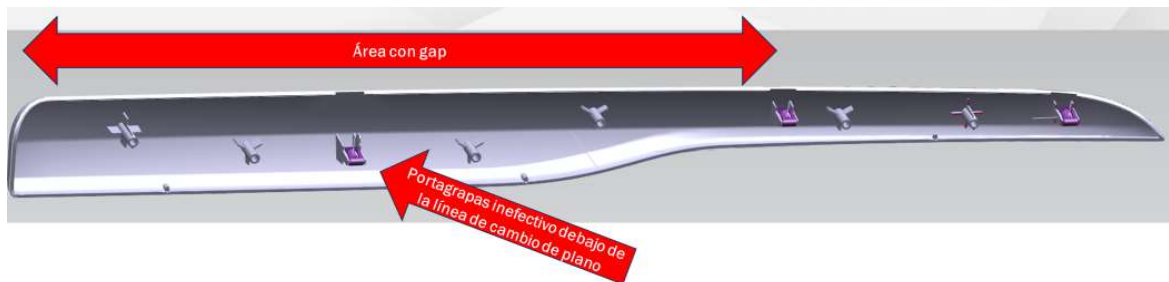
Ilustración 4.50.- Detalle del área crítica y portagrapas inefectivo. Fuente: (Grupo Antolín, 2016e)
