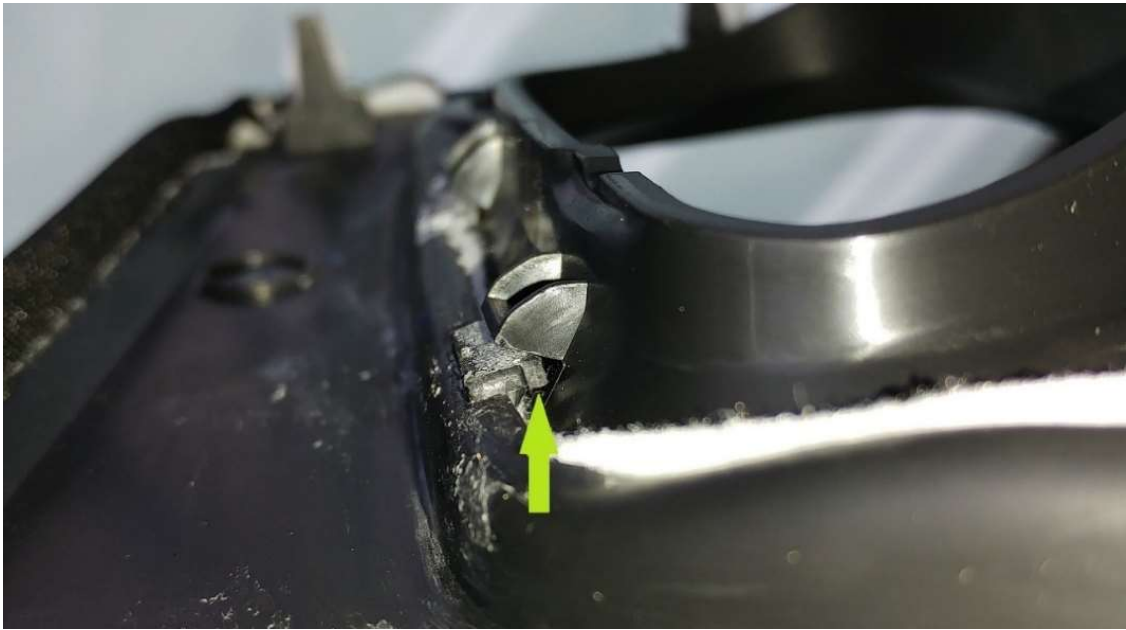
Ilustración 4.14.- Maquetaje añadiendo material a los puntos de clipaje del inserto. Fuente: Elaboración propia
