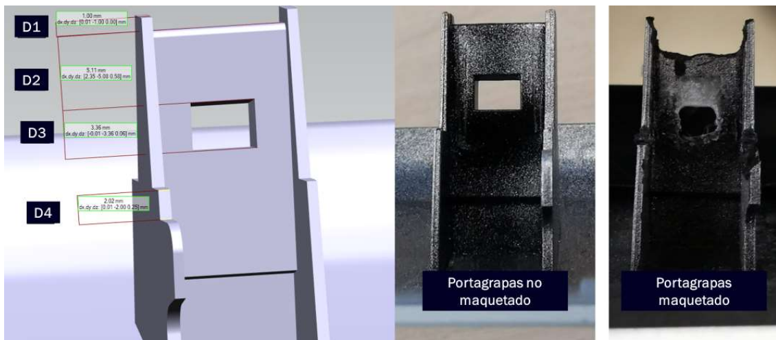
Ilustración 4.55.- Dimensiones modificadas de los portagrapas y aspecto de una grapa antemodificada y postmodificada. Fuente: Elaboración propia
