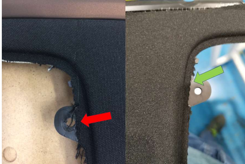
Ilustración 4.44.- Pieza denunciada por Stellantis y pieza tras la introducción del rebaje. Fuente: Elaboración propia
