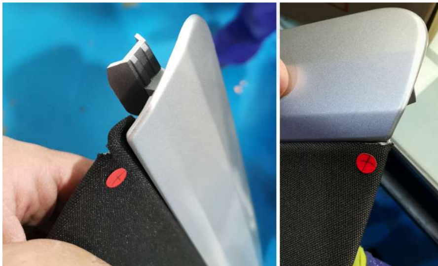
Ilustración 4.41.- Defecto de falta de recubrimiento en el poste B. Fuente: Elaboración propia
