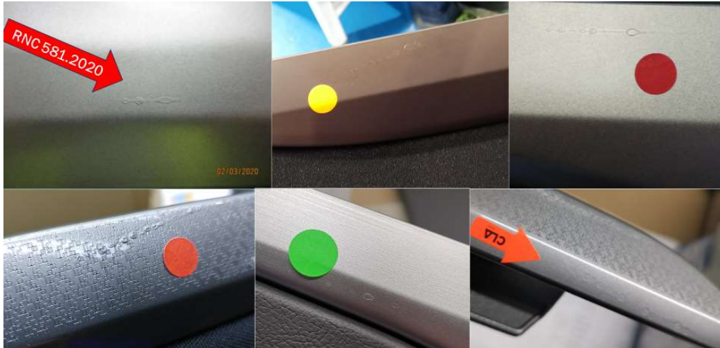
Ilustración 5.35.- Ejemplos aberrantes del defecto de gotas. Fuente: Elaboración propia
