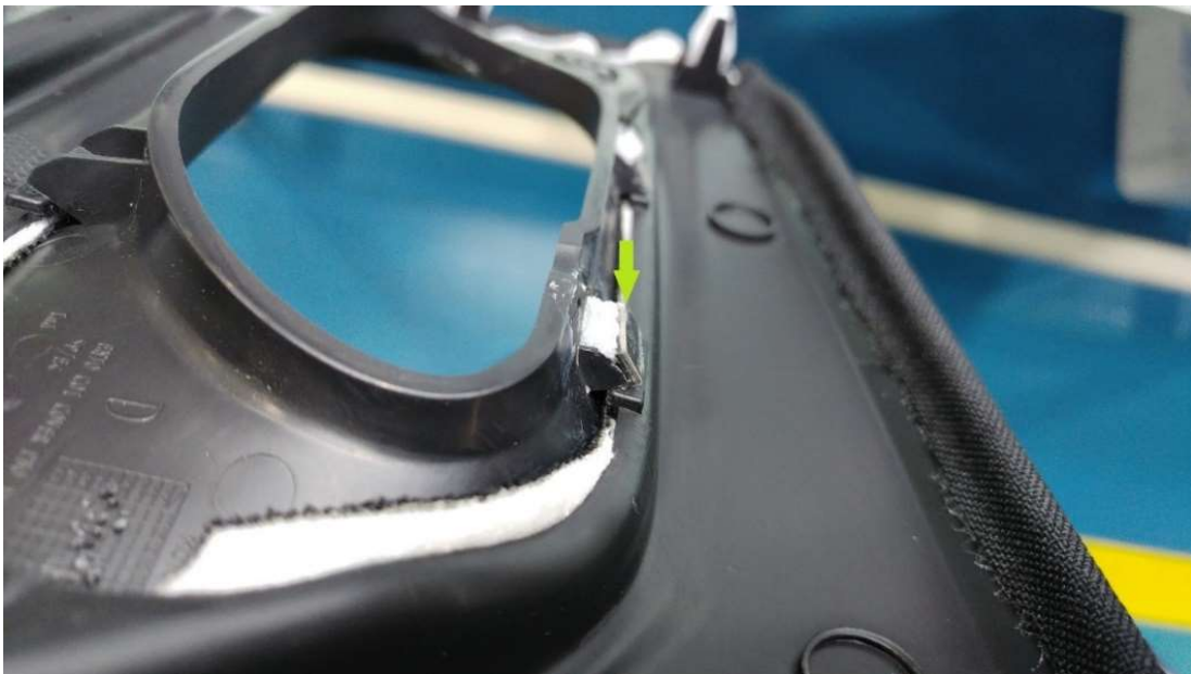
Ilustración 4.13.- Maquetaje añadiendo material a los puntos de clipaje de la COI. Fuente. Elaboración propia
