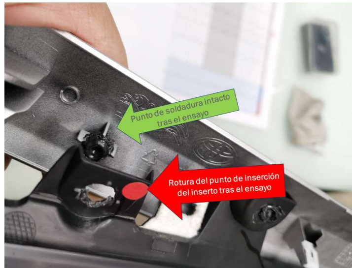
Ilustración 4.29.- Detalle del modo de rotura del punto de soldadura del poste B tras las acciones. Fuente: Elaboración propia
