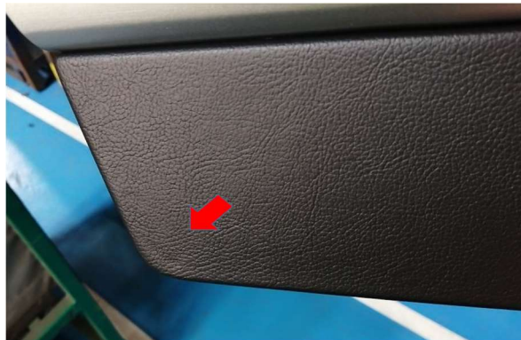
Ilustración 4.47.- Marcas en cara vista causadas por un exceso de presión en cara no vista. Fuente: Elaboración propia
