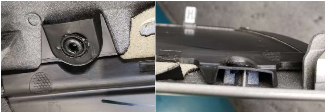
Ilustración 4.28.- Detalle de una buterola sin resquebrajamiento tras las acciones y aspecto superior con más diámetro y material. Fuente: Elaboración propia
