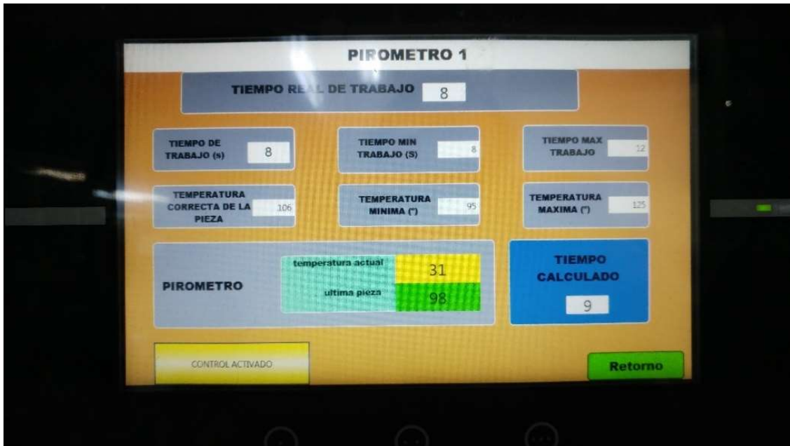
Ilustración 2.10.- Pantalla de control de tiempo de calentamiento de una máquina Van de Velde. Fuente: Elaboración propia
