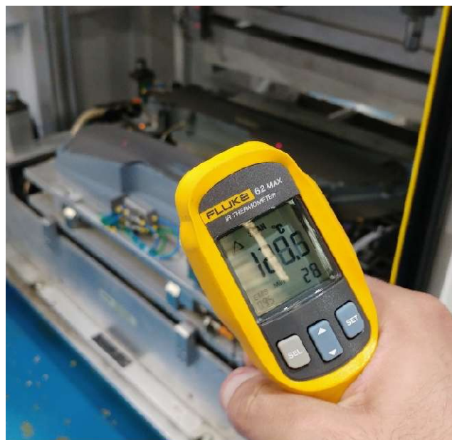
Ilustración 5.22.- Comprobación de la temperatura de un formato a la salida del calentamiento con un pirómetro manual. Fuente: Elaboración propia
