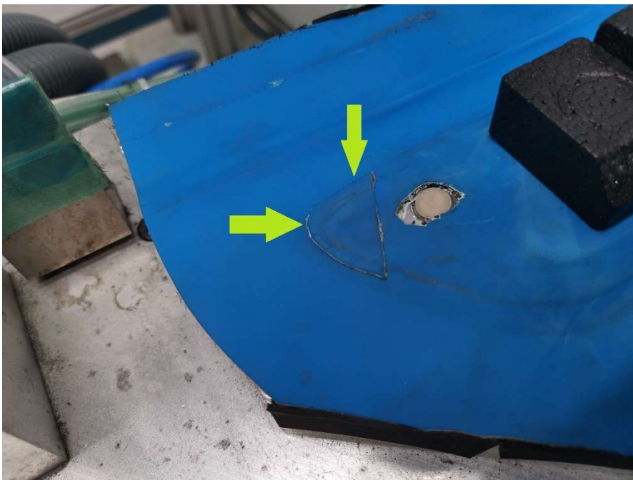
Ilustración 4.17.- Material extra adicionado en COI Rg1 de Robot Ergos para eliminar el desplacaje residual. Fuente: Elaboración propia
