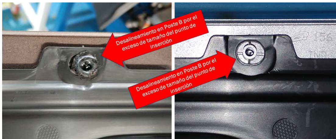
Ilustración 4.33.- Detalle del efecto de desalineamiento creado por el exceso de tamaño de los puntos de inserción. Fuente: Elaboración propia
