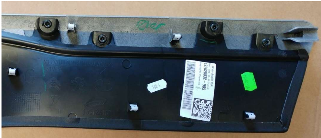
Ilustración 1.24.- Detalle de la etiqueta y la posición anterior a julio de 2020 en un medallón Rg1. Fuente: Elaboración propia
