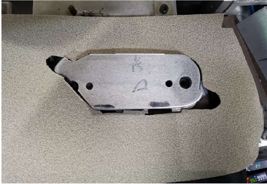
Ilustración 4.6.- Formato modificado para abrazar el postizo de centraje de COI. Fuente: Elaboración propia
