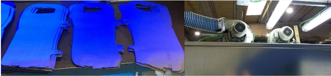
Ilustración 4.21.- Bloques de formatos adhesivados y set de turbinas de secado sobre la cámara de adhesivado. Fuente: Elaboración propia
