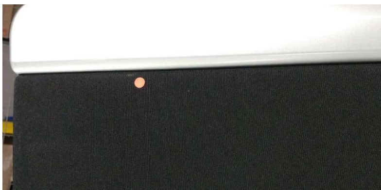
Ilustración 4.19.- Mancha de adhesivo en un medallón de Rg2. Fuente: Elaboración propia
