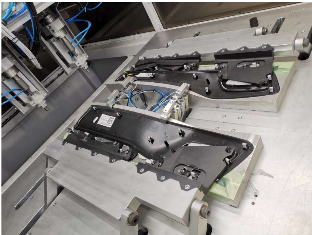
Ilustración 2.16.- Piezas sujetas por los cierres de la máquina en los instantes previos al inicio del proceso de soldadura. Fuente: Elaboración propia
