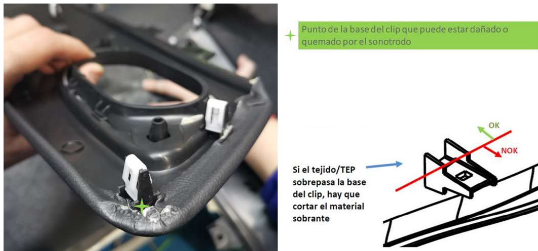
Ilustración 5.6.- Criterio de conformidad para el retoque con sonotrodo en Rg1. Fuente: Elaboración propia
