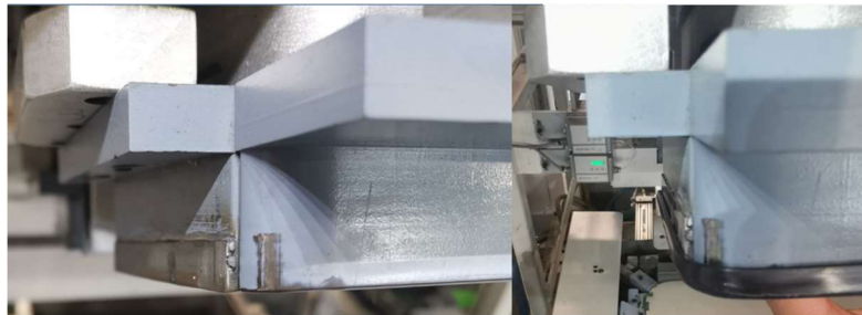
Ilustración 5.14.- Aspecto de la garra de rebordeo del poste C del Rg2 después de adicionar material. Fuente: Elaboración propia
