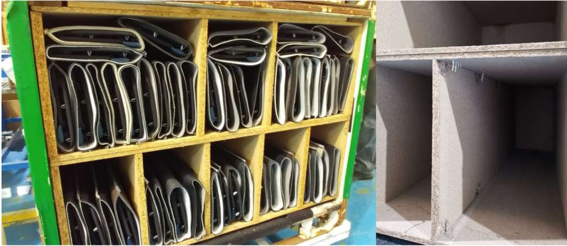
Ilustración 5.39.- Contenedores blancos y grapas sueltas en un contenedor dañado. Fuente: Elaboración propia
