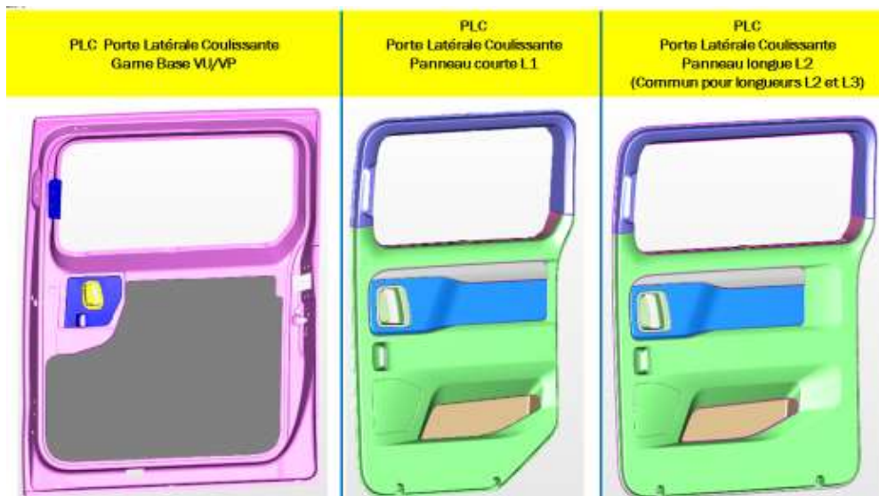
Ilustración 1.9.- Comparativa entre panel tipo brisement de Rango2 VU y guarnitura de panel de Rango2 en versiones L1 y L2. Fuente: (Grupo Antolín, 2015)
