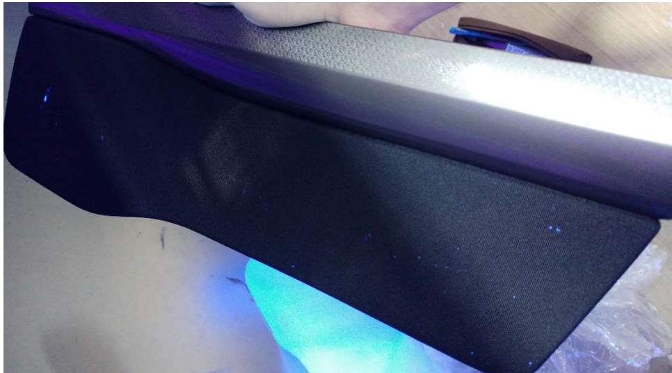
Ilustración 4.20.- Medallón Rg3 con manchas de adhesivo reveladas gracias a la luz ultravioleta. Fuente: Elaboración propia
