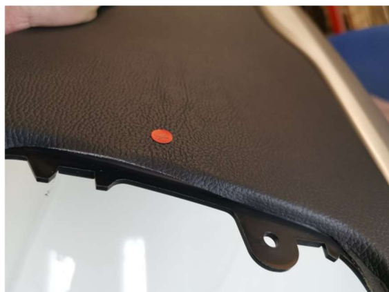
Ilustración 4.43.- COI Rg2 con formato descentrado y falta de recubrimiento. Fuente: Elaboración propia
