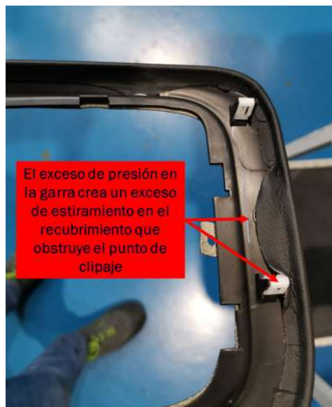
Ilustración 5.17.- Estiramiento excesivo del recubrimiento en el rebordeo causado por un ajuste erróneo de la garra de sujeción. Fuente: Elaboración propia
