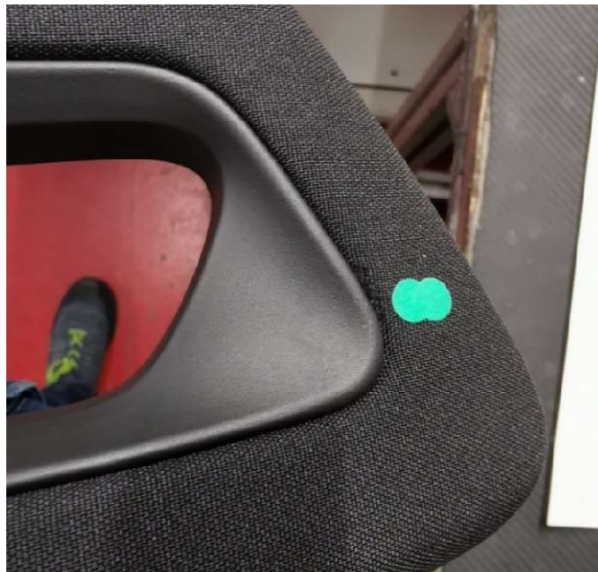
Ilustración 4.7.- Defecto de material corto en una COI Rg1. Fuente: Elaboración propia
