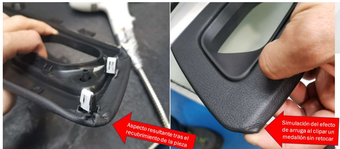
Ilustración 5.5.- Rebordeo NOK tras vestido y simulación del impacto en cliente. Fuente: Elaboración propia
