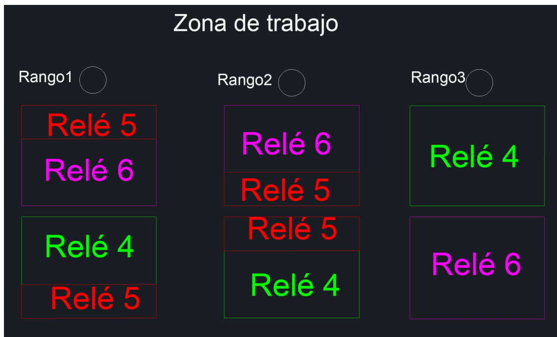
Ilustración 5.23.- Distribución de los relés de los moldes KO en cada bloque de resistencias. Las sondas de temperatura para el modo en espera y los pirómetros internos están en el centro de cada bloque de resistencias. Fuente: Elaboración propia
