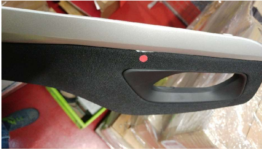
Ilustración 4.40.- Defecto de falta de recubrimiento en la zona de contacto con baguette : Fuente: Elaboración propia
