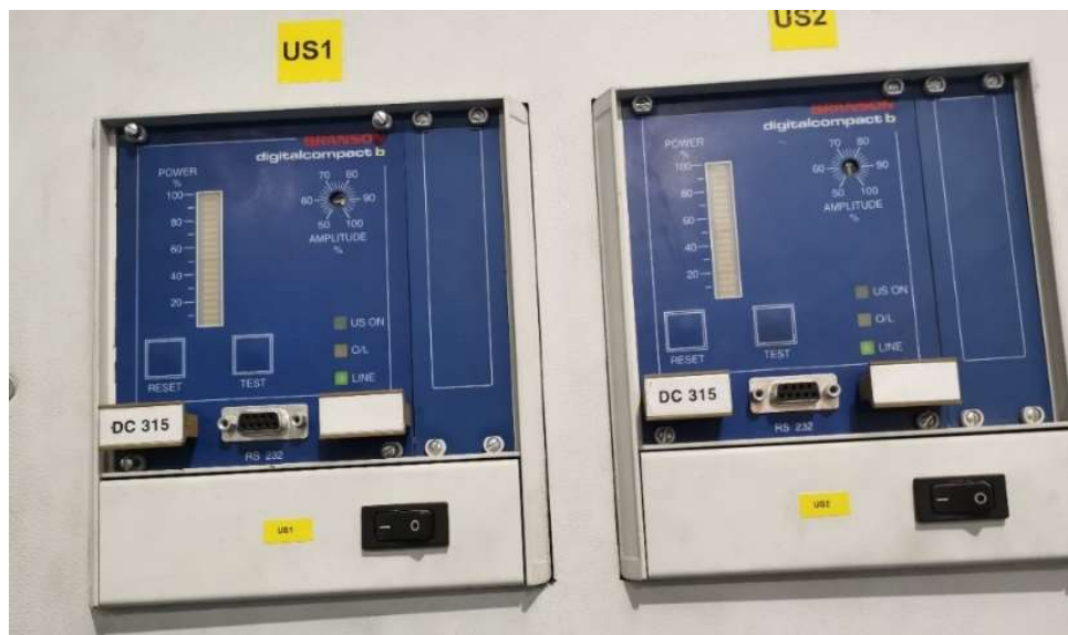
Ilustración 2.18.- Sistema de selección de amplitud de soldadura. Independiente para cada sonotrodo en la máquina Bocanegra. Fuente: Elaboración propia
