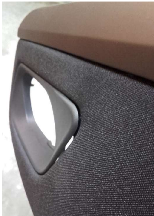
Ilustración 4.3.- Deplacaje o afloramiento extremo en un medallón KO Rg1 derecho. Fuente: Elaboración propia
