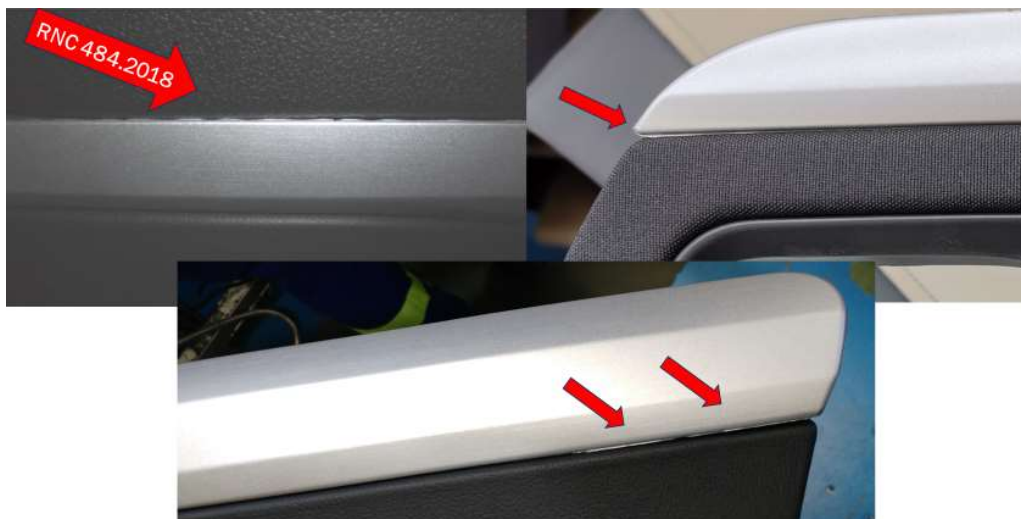
Ilustración 5.32.- Ejemplos de rebabas NOK. Fuente: Elaboración propia
