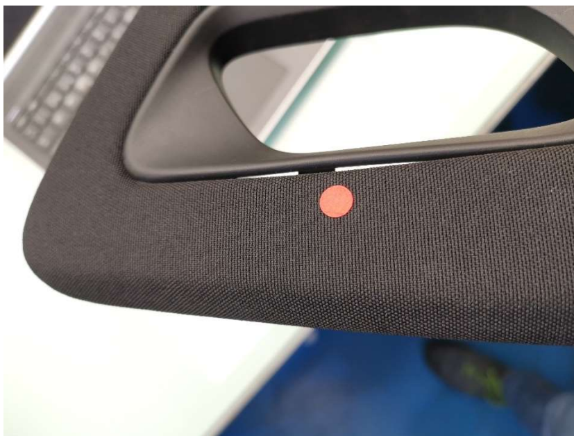
Ilustración 4.10.- COI de un medallón Rg1 con problema de desclipaje. Fuente: Elaboración propia
