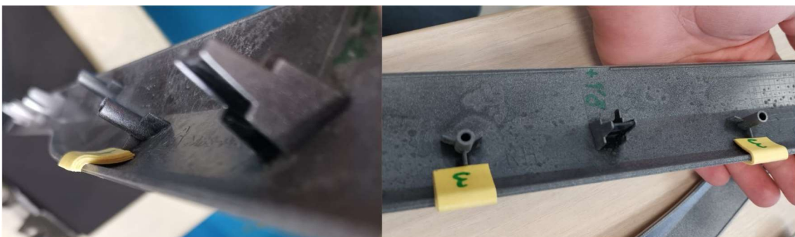
Ilustración 4.52.- Maquetaje en la baguette para reducir el gap . Fuente: Elaboración propia
