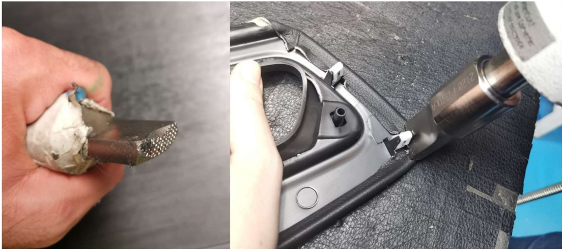
Ilustración 5.8.- Sonotrodo curvo actual y captura del proceso de retoque. Fuente: Elaboración propia
