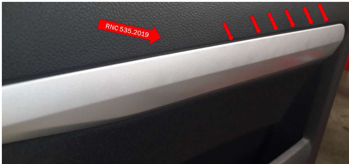
Ilustración 5.33.- Detalle de la no conformidad por marbling en Stellantis. Fuente: Elaboración propia
