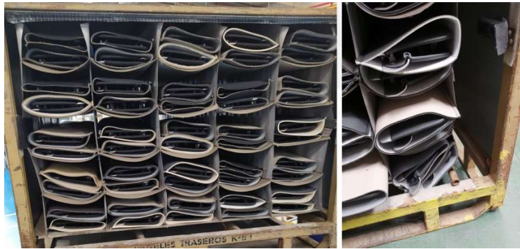
Ilustración 5.43.- Contenedor X84 y problemática de deformaciones en alveolos por falta de rigidez. Fuente: Elaboración propia
