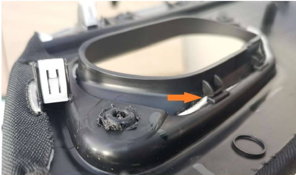
Ilustración 4.11.- Medallón Rg1 con uno de los puntos de clipaje ligeramente solapado por el recubrimiento. Fuente: Elaboración propia
