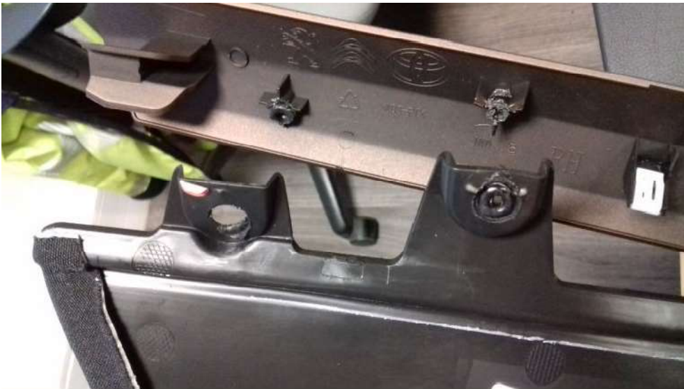
Ilustración 4.26.- Detalle de un medallón con rotura en los puntos de soldadura. Fuente: Elaboración propia
