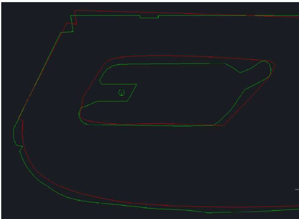
Ilustración 4.5.- Comparativa entre el formato original del Tejido Rg1 (rojo) y el introducido en marzo 2018 que mejora el centraje del formato (verde). Fuente: (Dpto. Ingeniería GA RyA, 2022c)
