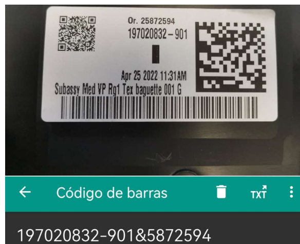
Ilustración 1.23.- Detalle de la etiqueta actual con los códigos y el número de orden, y la lectura obtenida del QR grande y el código de barras. Fuente: Elaboración propia
