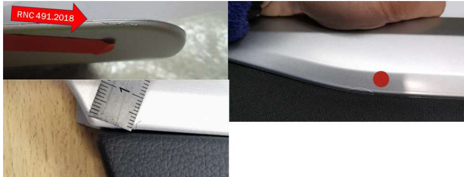
Ilustración 5.31.- Ejemplos de impurezas causadas por rebabas. Fuente: Elaboración propia
