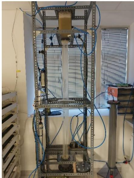
*Figura 5. Reactor de Flujo de Taylor para producción de ectoína empleado en el laboratorio del Instituto de Procesos Sostenibles.*
