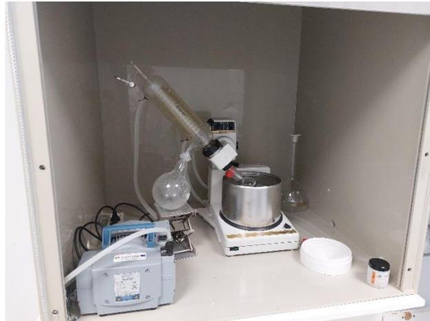
Figura 14. Rotavapor utilizado en la fase experimental.
