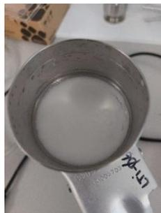
Figura 16. Precipitado recogido durante el filtrado.
