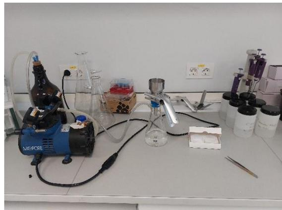
Figura 15. Equipo utilizado para el filtrado del precipitado formado tras la adición del metanol.
