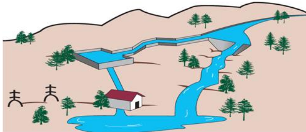
Figura 2.7: Esquema de una central de "agua fluyente".
