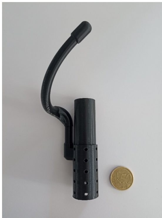
Fig. 83. Pieza del soporte del motor y pulgar impresa.
