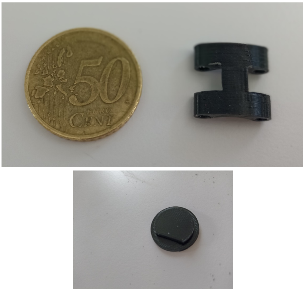
Fig. 85. Piezas Junta de unión y tapa impresas.
