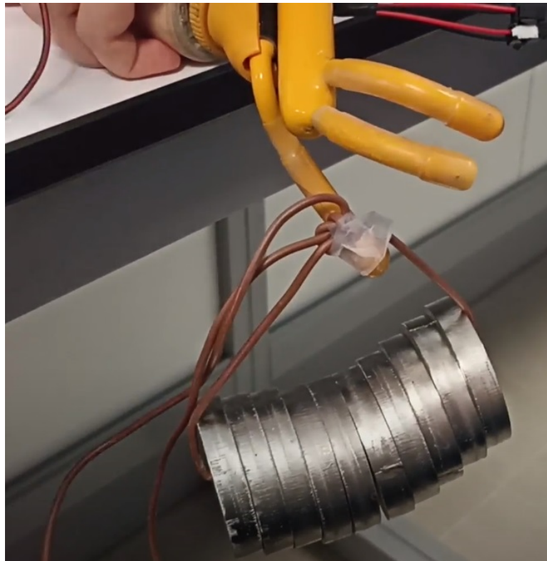
Fig. 136. Momento del ensayo de fuerza sobre la mano ElectroHand 2000 .
