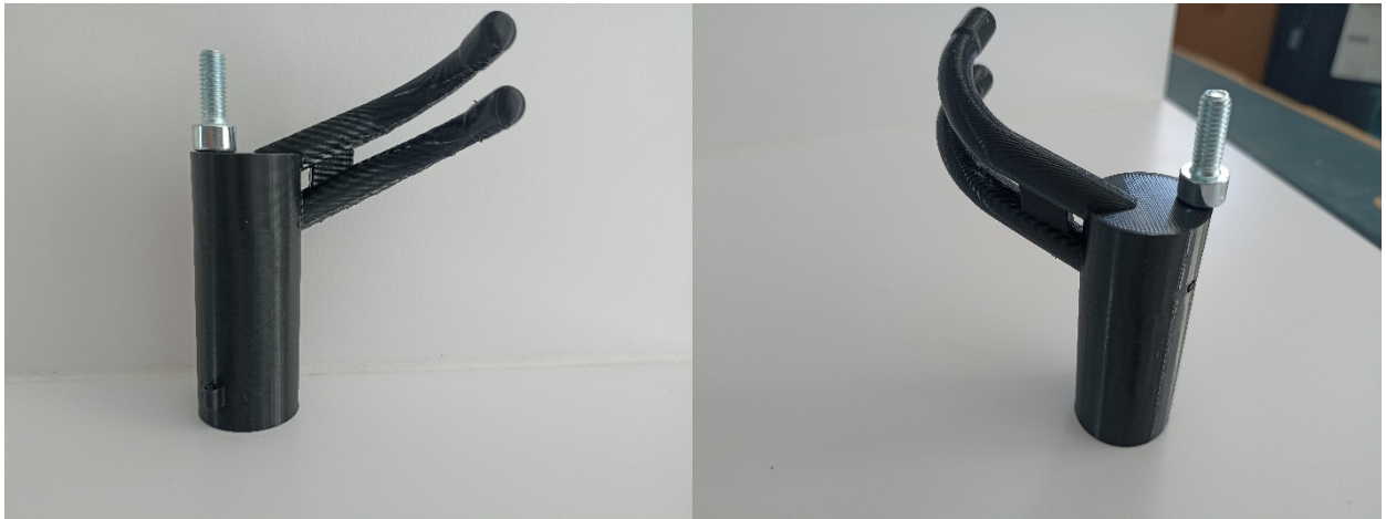
Fig. 84. Pieza de los dedos índice y medio impresa.
