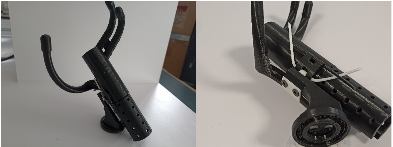
Fig. 86. Prótesis completa impresa y ensamblada.
