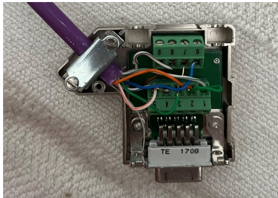
Figura 6.5: Conexión manual del cabezal hembra D-SUB9
