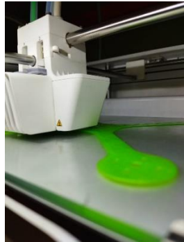
Ilustración 42 . Vista en detalle del proceso de impresión del frame
