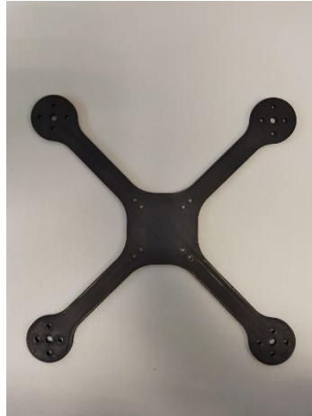
Ilustración 31 . Versión final del frame impresa en 3D
