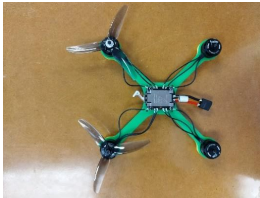
Ilustración 64 . Placa de ESC y motores instalados en el frame del dron
