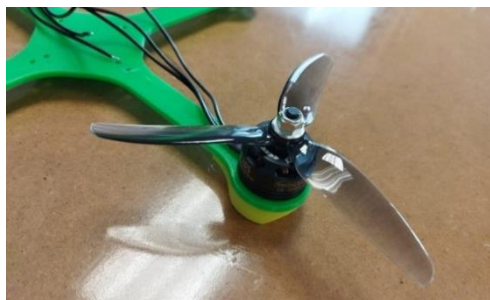
Ilustración 63 . Protección para aterrizaje fija al frame
