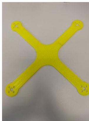
Ilustración 23 . Primera versión del frame impresa en 3D
