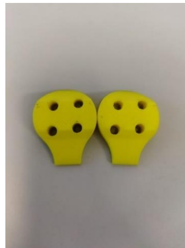
Ilustración 33 . Protección de aterrizaje impresa en 3D
