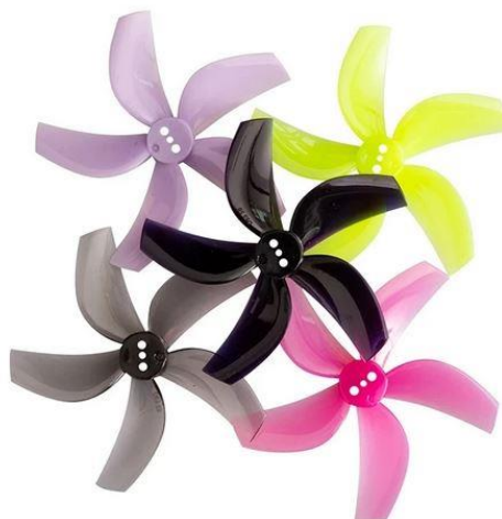
Ilustración 12 . Hélices de policarbonato de cinco palas. Recuperado de https://banggood.com
