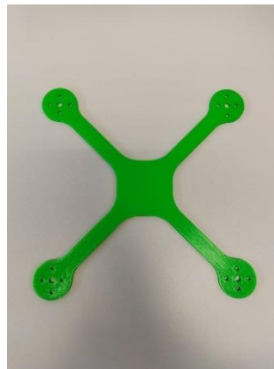
Ilustración 25 . Segunda versión del frame impresa en 3D
