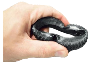
Ilustración 52 . Rueda impresa en TPU. Recuperado de https://tractus3d.com/es/materials/tpu/
