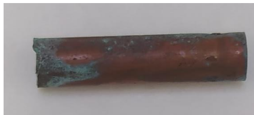
Figura 49 Probeta de cobre ensayada durante 40 horas en cámara de niebla salina.
