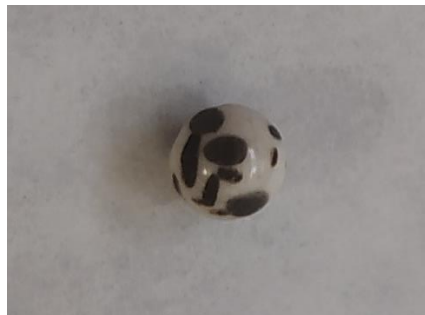
Figura 74: Bola de alúmina desgastada.
