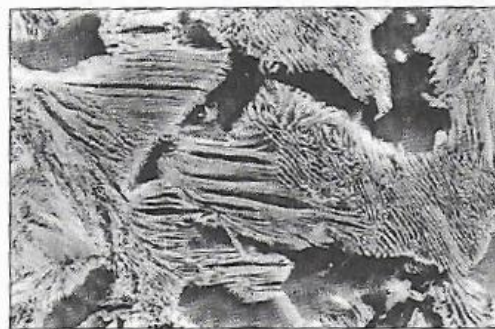
Figura 4: Imagen obtenida mediante microscopía electrónica de barrido mostrando el ataque selectivo sobre la ferrita en un acero hipoeutectoide. [1]
