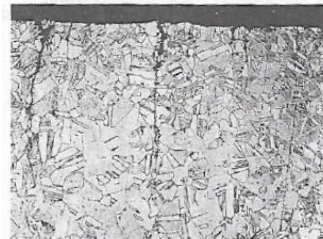
Figura 19: Rotura transgranular en bronce por corrosión bajo tensión. [1]
