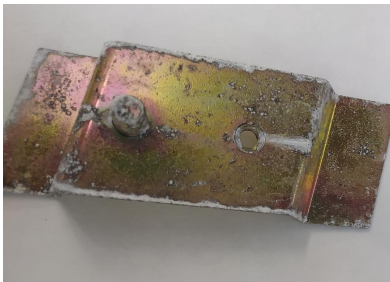
Figura 47: Probeta de acero electrocincado ensayada durante 40 horas en cámara de niebla salina.
