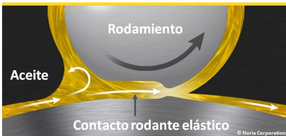
Figura 38: Representación del funcionamiento de la lubricación elastohidrodinámica (EHL).[14]
