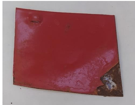
Figura 48: Probeta de acero al carbono pintada y ensayada en cámara de niebla salina durante 40 horas.
