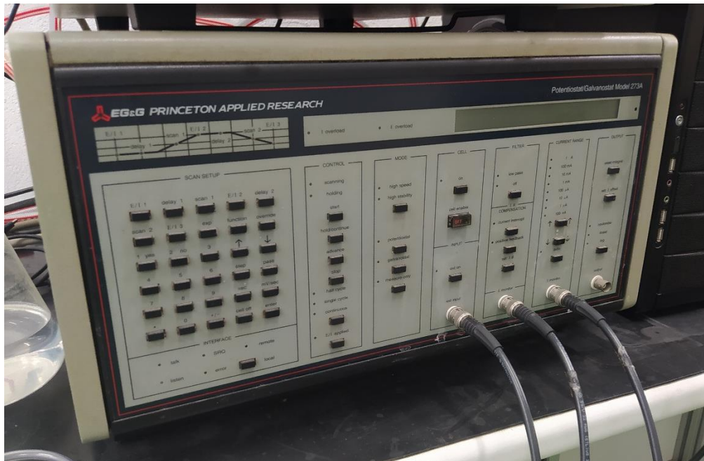
Figura 54: Potenciostato con el que se realizan los ensayos de potencial a circuito abierto y de polarización anódica.
