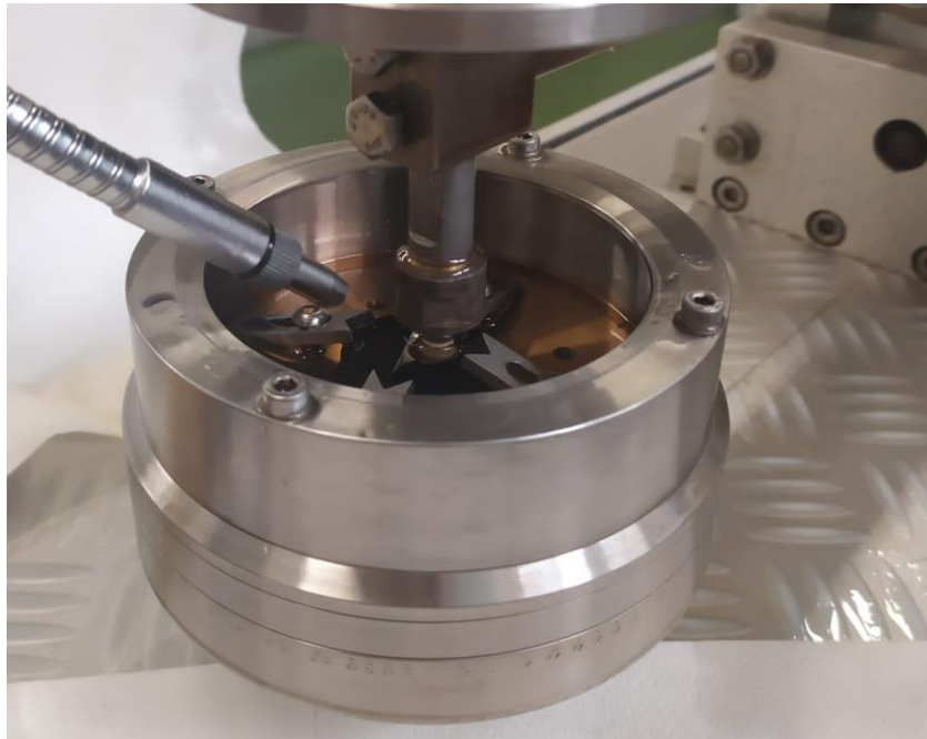
Figura 85: Situación una vez finalizado un ensayo de desgaste circular lubricado.
