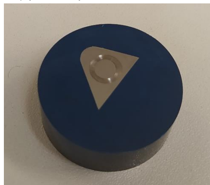
Figura 78: Huella circular en probeta desgastada mediante un ensayo de desgaste circular seco.
