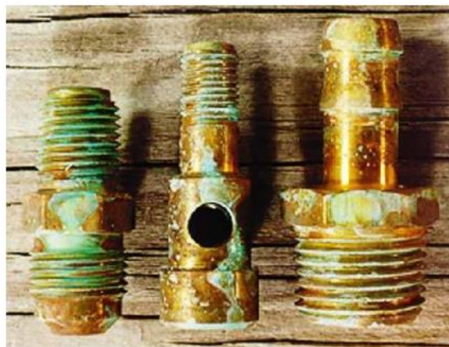
Figura 5: Descincificación del latón. [4]
