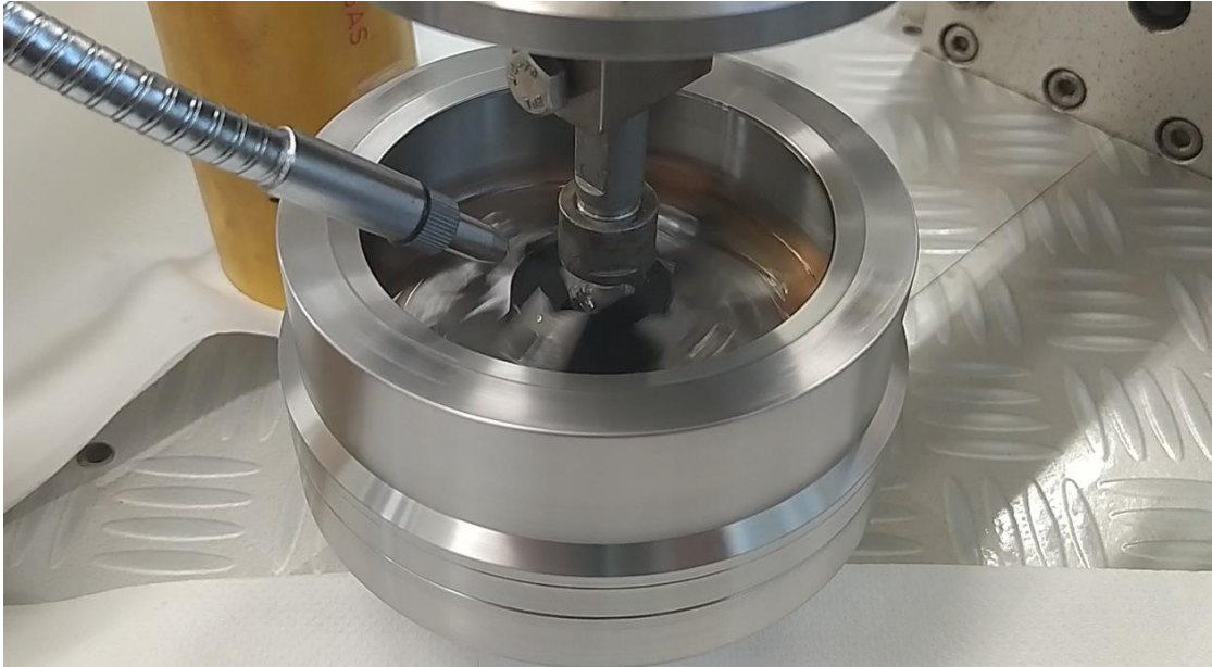
Figura 82: Situación con acumulación de lubricante después de un cierto periodo de ensayo.
