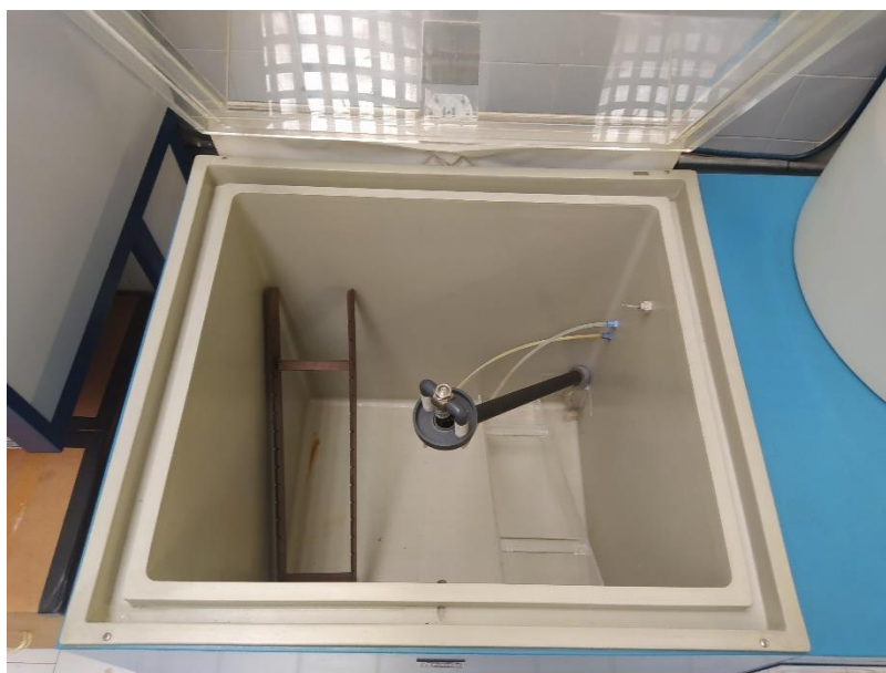
Figura 44: Vista superior de la cámara de niebla salina desde donde podemos ver el canal lateral, los soportes, los capilares y el difusor encargado de la generación de la niebla.
