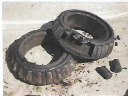
Figura 34: Rodamiento desgastado por corrosión. [10]
