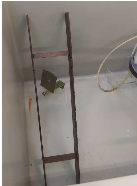
Figura 43: Probeta de acero electrocincado colgada en un soporte dentro de la cámara de niebla salina antes de comenzar el ensayo.
