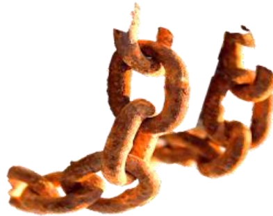
Figura 1: Ejemplo de corrosión uniforme. [3]
