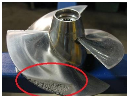
Figura 36: Desgaste por cavitación en la hélice de una turbina. [13]
