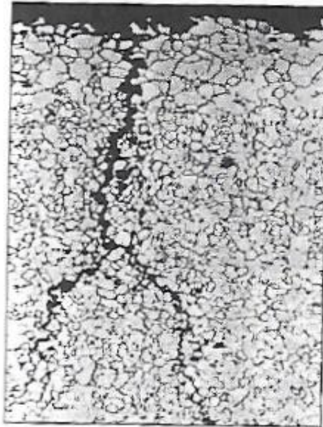
Figura 18: Rotura intergranular en acero al carbono provocada por corrosión bajo tensión. [1]
