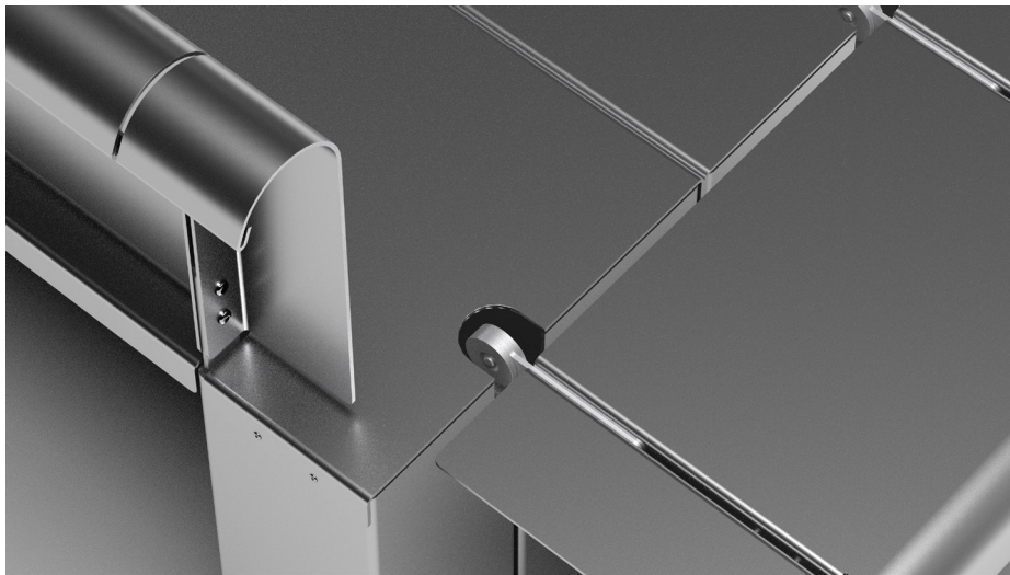
Fig. 68. Detalle uniones pletina y bisagra. Elaboración propia.
