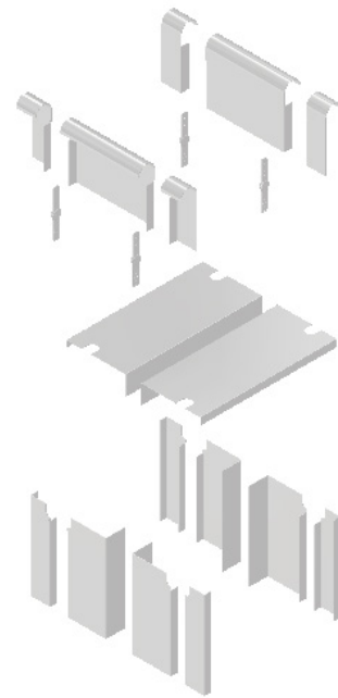
Fig. 52. Explosión de estructura base con reposabrazados. Elaboración propia.
