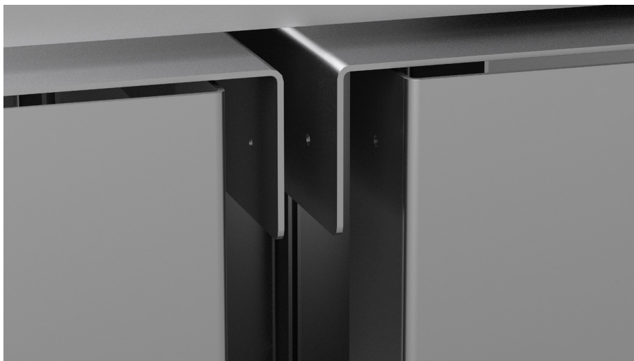
Fig. 69. Detalle unión asientos - patas centrales. Elaboración propia.
