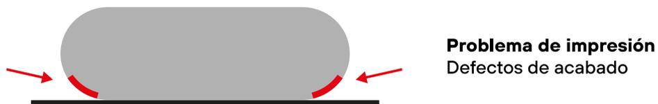
Figura 32 – Representación gráfica las zonas críticas de impresión de la pieza interior
