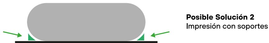
Figura 43 – Solución 2 a la zona crítica de impresión utilizando soportes
