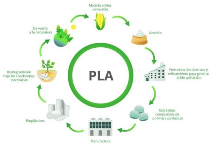
Figura 16 – Proceso circular de la obtención del plástico PLA
