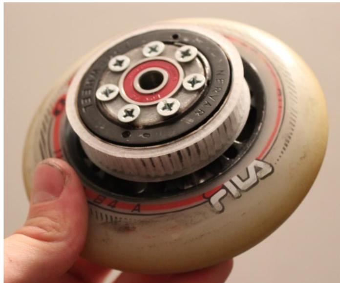
*Ilustración 79. Ensamblaje de la rueda libre compuesta V3 impresa en PETG y la rueda de 110mm*
