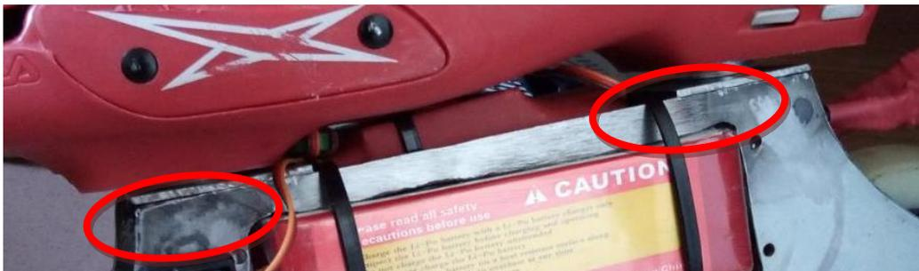
Ilustración 71. Detalle sobre los puntos de anclaje y la compensación entre sistemas FSK y UFS
