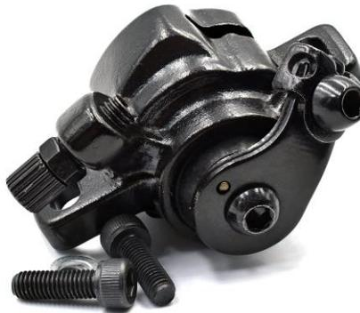
*Ilustración 103. Pinza de freno original, Patinete Xiaomi M365*
