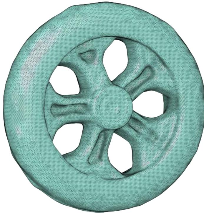
*Ilustración 100. Rueda de 145 mm "mesh" o malla resultante, fotogrametría*
