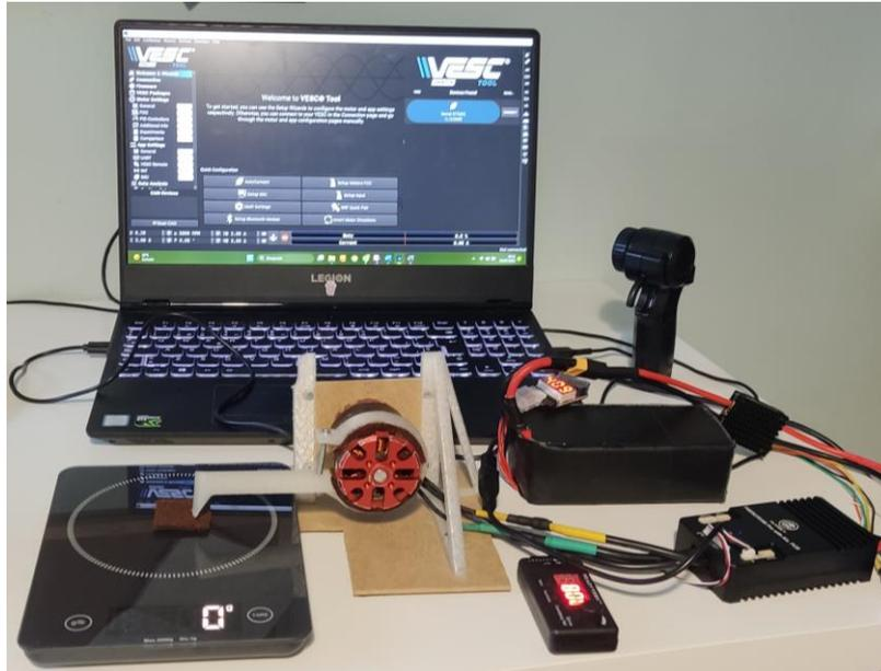
*Ilustración 137. Montaje del ensayo, Freno de Prony para medida de  $K_T$  en motor N5065*
