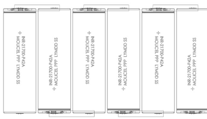
Ilustración 128. Conexiones serie
