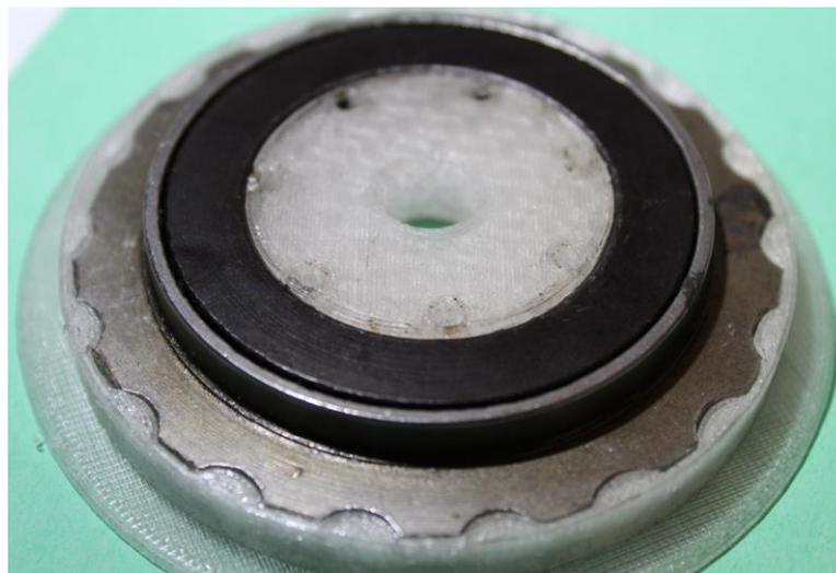
*Ilustración 52. Ensamblaje de la rueda libre compuesta V1*
