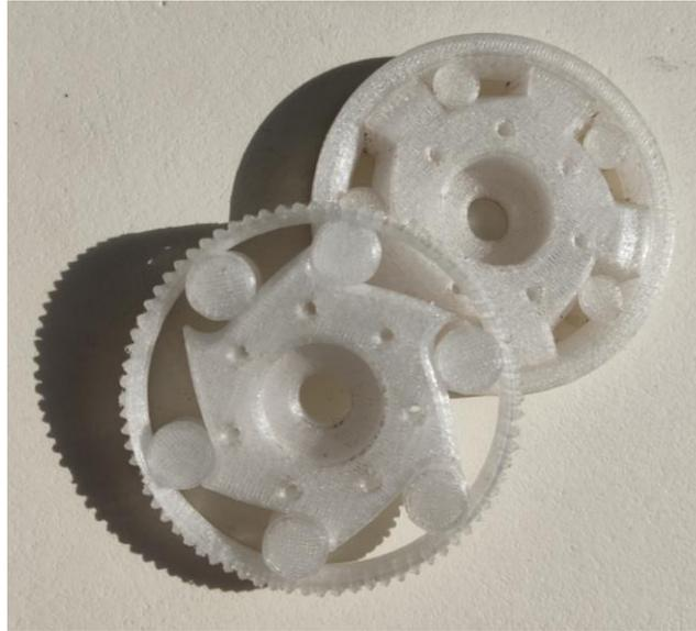
*Ilustración 49. Distintas iteraciones de diseño de la rueda libre*
