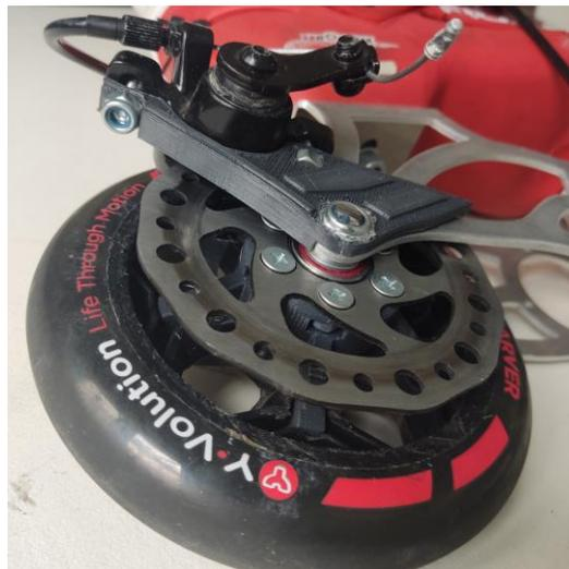
*Ilustración 106. Detalle del sistema de frenada activa, prototipo Mk2*
