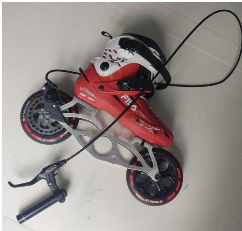
*Ilustración 109. Sistema de frenada activa completo, patín derecho del Prototipo Mk2*
