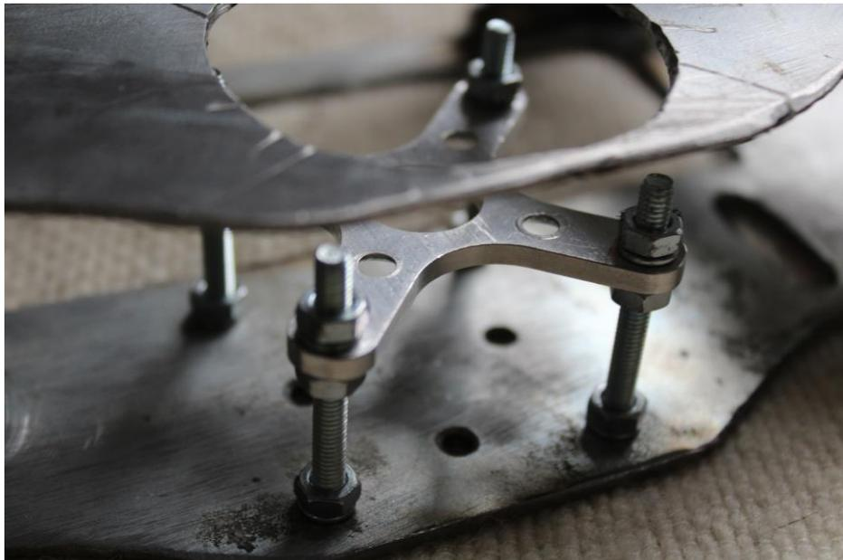
*Ilustración 66. Detalle del anclaje para el motor N5065 en la estructura del prototipo Mk1*
