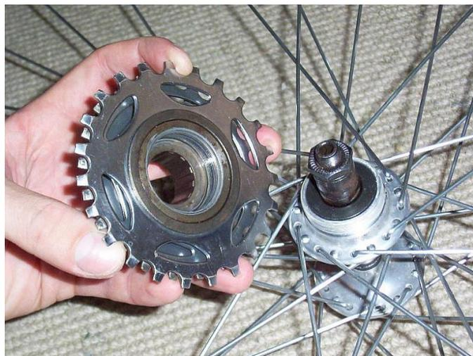
Ilustración 46. Rueda libre integrada en casete de bicicleta convencional [30]
