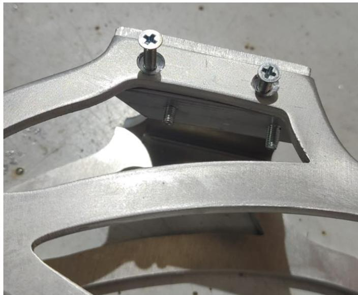
*Ilustración 97. Unión de la estructura Mk2 mediante perfil de aluminio 10x10 mm*
