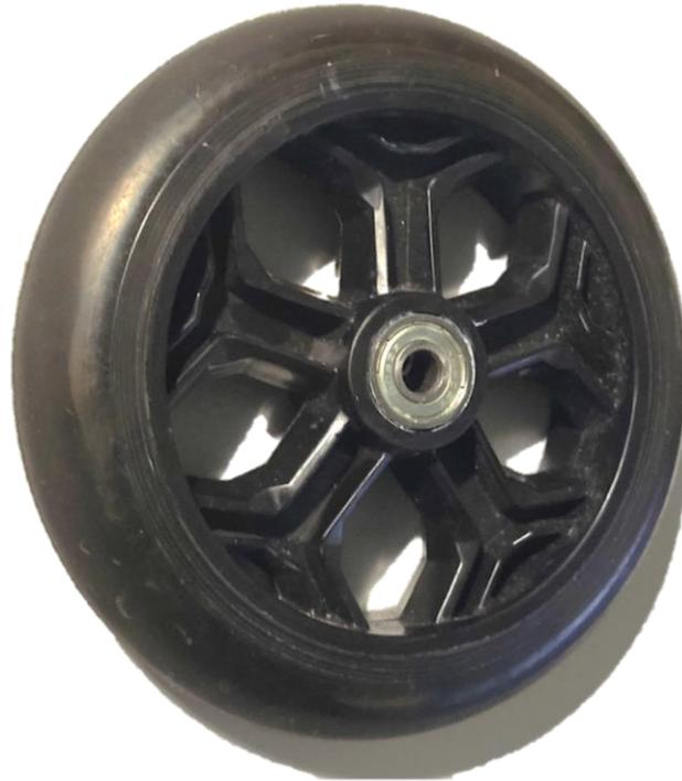
*Ilustración 99. Rueda de 145 mm, rodamientos ABEC 7, Prototipo Mk2*
