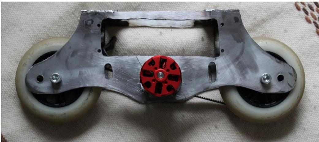
*Ilustración 68. Ensamblaje completo de los componentes mecánicos del SPE, prototipo Mk1*
