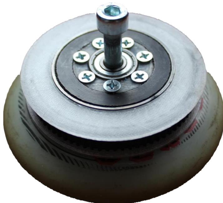
*Ilustración 54. Ensamblaje final de la rueda libre compuesta sobre rueda de 110 mm*
