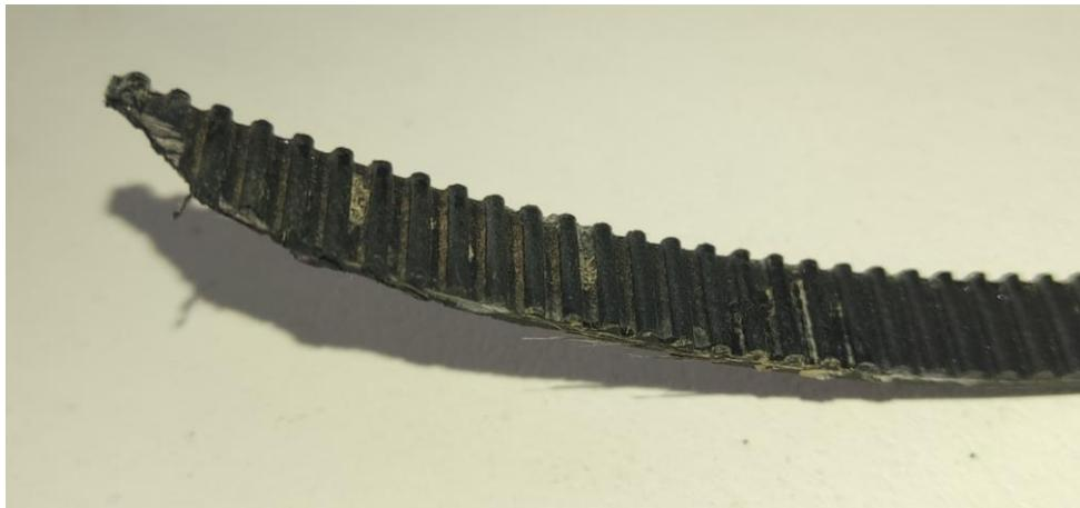
*Ilustración 72. Deterioro y rotura de la correa durante la primera fase de pruebas del prototipo Mk1*
