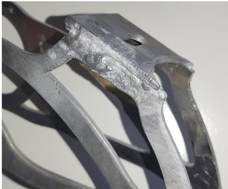
*Ilustración 96. Intentos de soldadura sobre raíl de 3 mm, prototipo Mk2*
