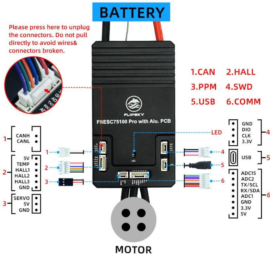
Ilustración 121. Conexiones VESC FlipSky F8ESC75100 Pro [29]
