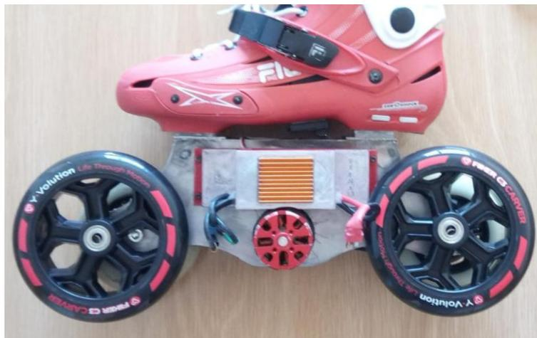
Ilustración 98. Comparativa de tamaño, ruedas de 145mm sobre el prototipo Mk1 Fase 2
