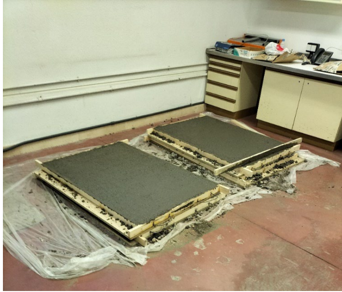
Fig. 37 Losas de hormigón fabricadas, estando el hormigón aun fresco.
