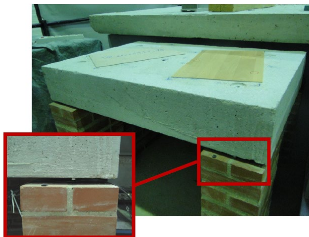
Fig. 13 Montaje de la muestra según la norma que define un método alternativo para el estudio de forjados pesados, UNE-EN ISO 16251-1. [Foret]
