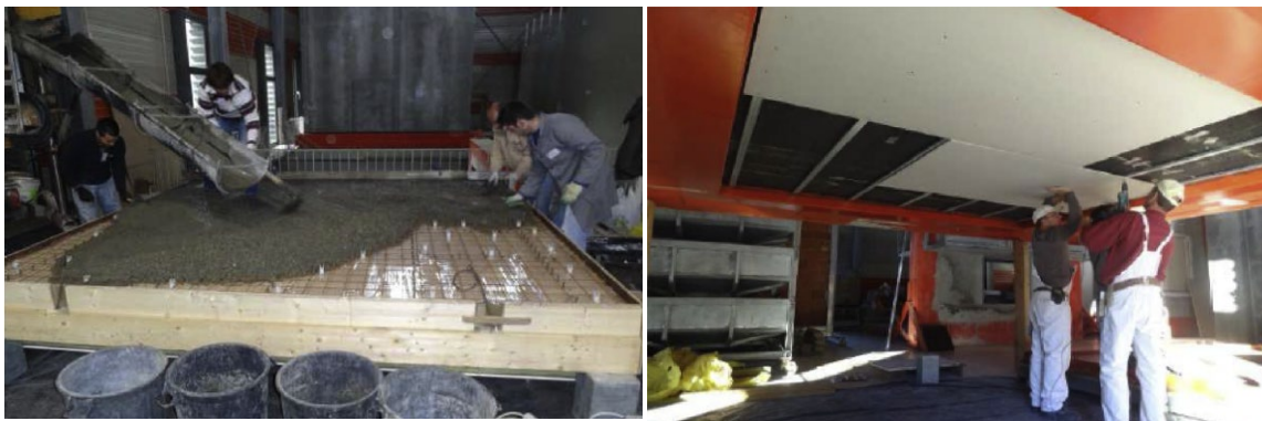
Fig. 10 Algunas imágenes del montaje del ensayo para la caracterización de los revestimientos según la norma descrita en el apartado 2.1. de este documento. [Martins]
