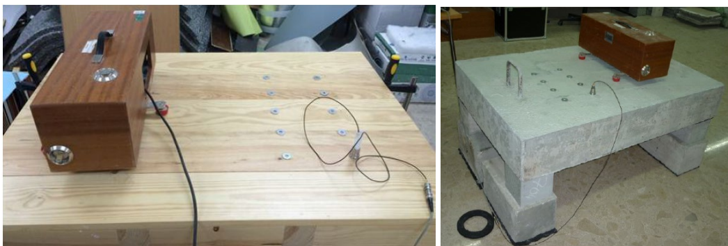
Fig. 16 Placa de madera (izquierda), y losa de hormigón (derecha), ambas de dimensiones semejantes a lo definido en la norma UNE-EN ISO 16251-1, y con la cadena de medida instalada. En ambas, el acelerómetro está adherido en la parte superior del montaje. [Pereira]
