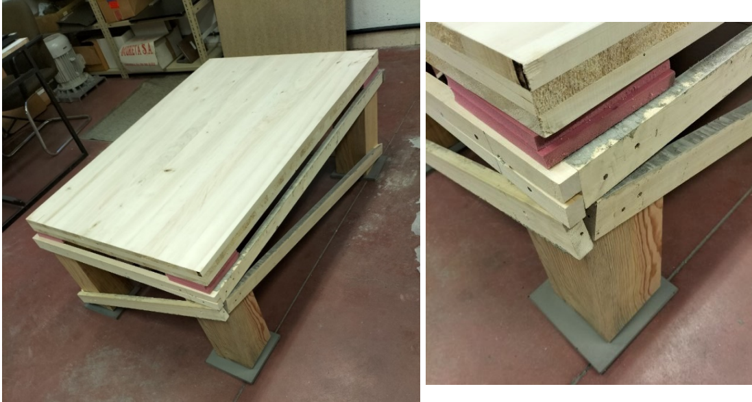
Fig. 41 Estructura soporte, junto al tablero de CLT (izquierda), modo de colocación de las planchas de Sylomer (derecha)
