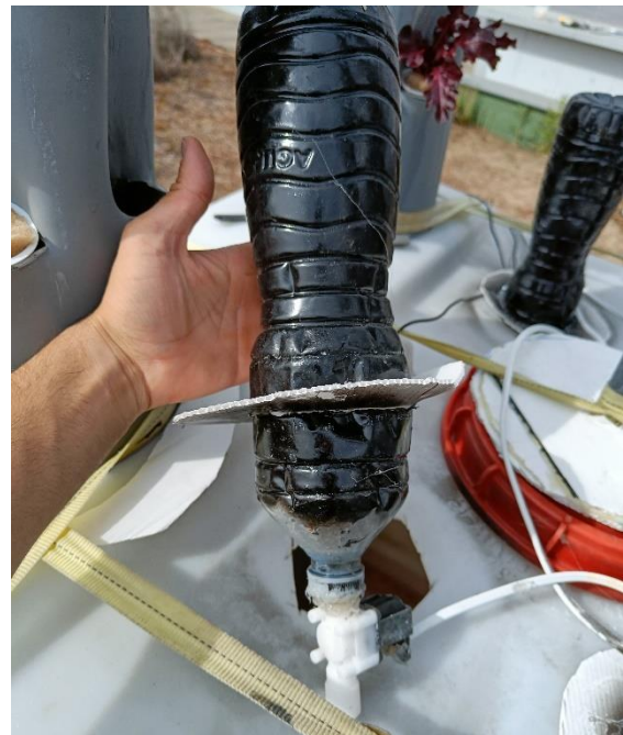
Ilustración 24. Botellas con electroválvula en el tapón
