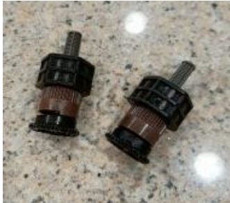
Ilustración 21. Aspersores colocados en las salidas del tubo
