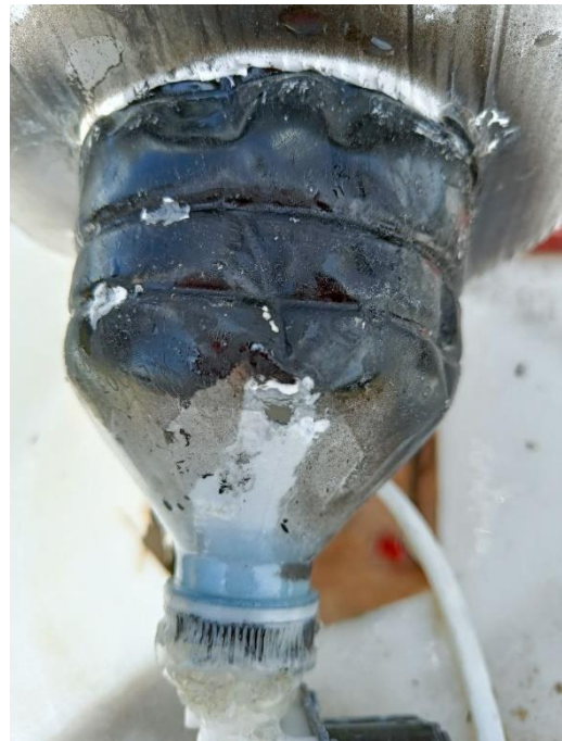
Ilustración 171. Botella en proceso de descomposición por el NaOH
