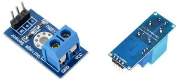
Ilustración 61. Medidor de voltaje comercial FZ0430. https://www.luisllamas.es/medir-voltajes-de-hasta-25v-con-arduino-y-fz0430/
