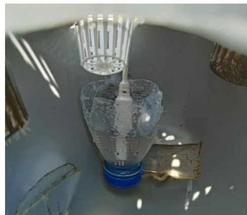
Ilustración 165. Sensor de EC en el mini-depósitos
