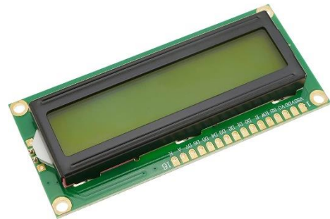
Ilustración 97. Display LCD 16x2. https://www.amazon.es/BeMatik-electr%C3%B3nico-Display-Amarillo-retroiluminado/dp/B07N2T5FW2
