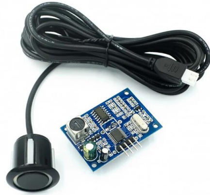
Ilustración 51. Módulo ultrasónico impermeable JSN-SR04 con módulo de control AJ-SR04M. https://lc.cx/VWLz49
