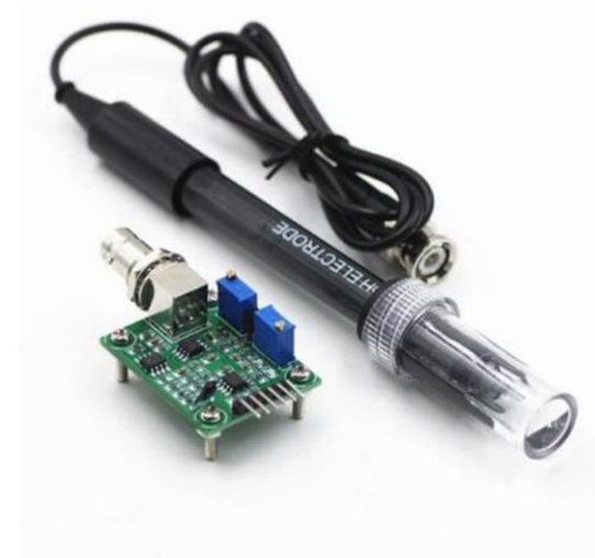
Ilustración 34. Sonda electrodo de pH BNC y módulo de detección del valor. https://lc.cx/4scpH6
