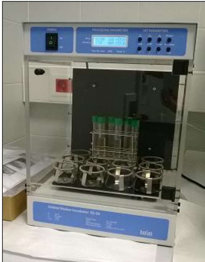
Foto 9. Incubadora a 37°C donde se incuban las muestras durante 15 min hasta su medición en el espectrofotómetro (ensayo 2).
