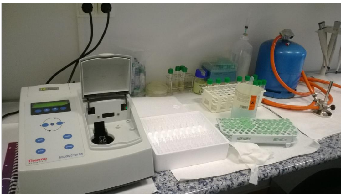
Foto 7. Mediciones en el espectrofotómetro de las diferentes diluciones seriadas
