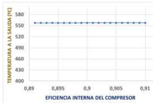
Gráfica 3. Temperatura a la salida de la turbina frente a la eficiencia interna del compresor.
