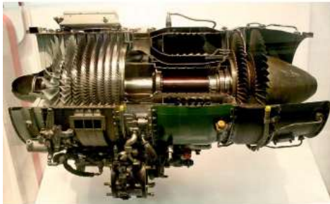
Figura 11. Turbina de gas. [13]
