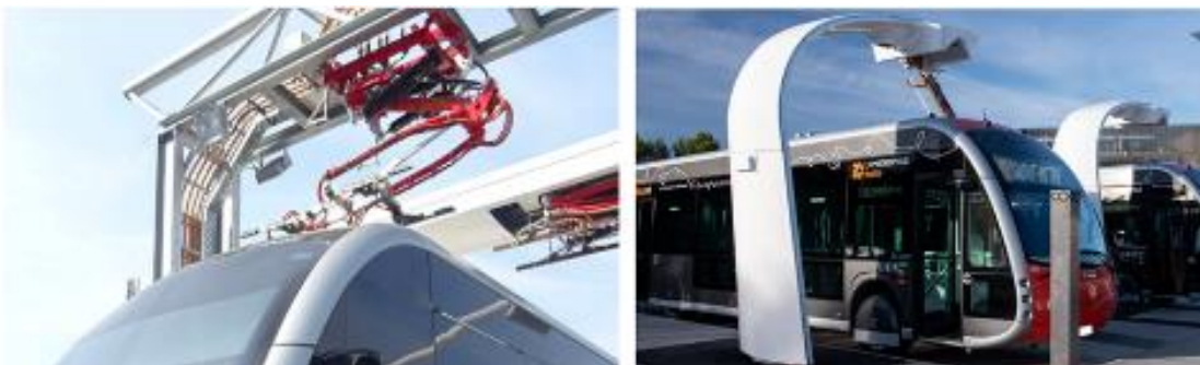
Figura 3.2. Puntos de carga para buses eléctricos. Fuente: Irizar e-mobility [59].
