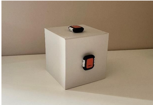
Figura 29. Posición de las dos IMUs en el sólido rígido.
