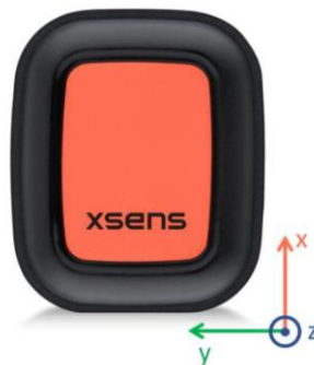
Figura 10. Sistema de coordenadas del sensor Xsens DOT [23].
