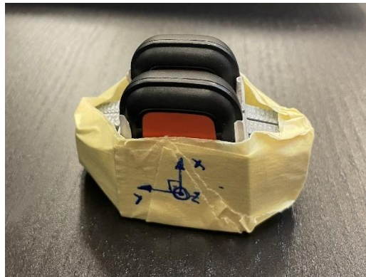
Figura 14. Posición de los sensores en la caja.
