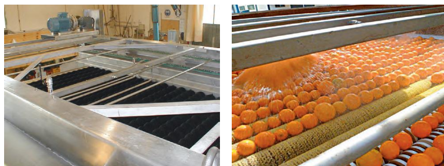
Figura nº4: Sistema de lavado
