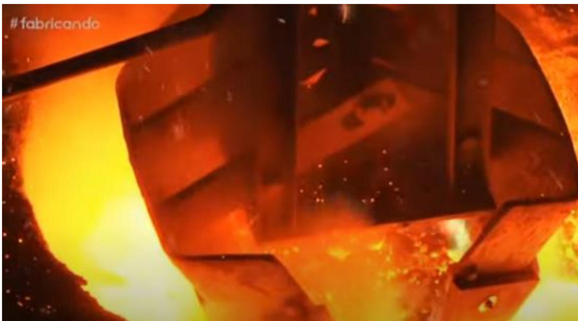
Figura 4: Proceso de recogida de la escoria de proceso de fundición [4]
