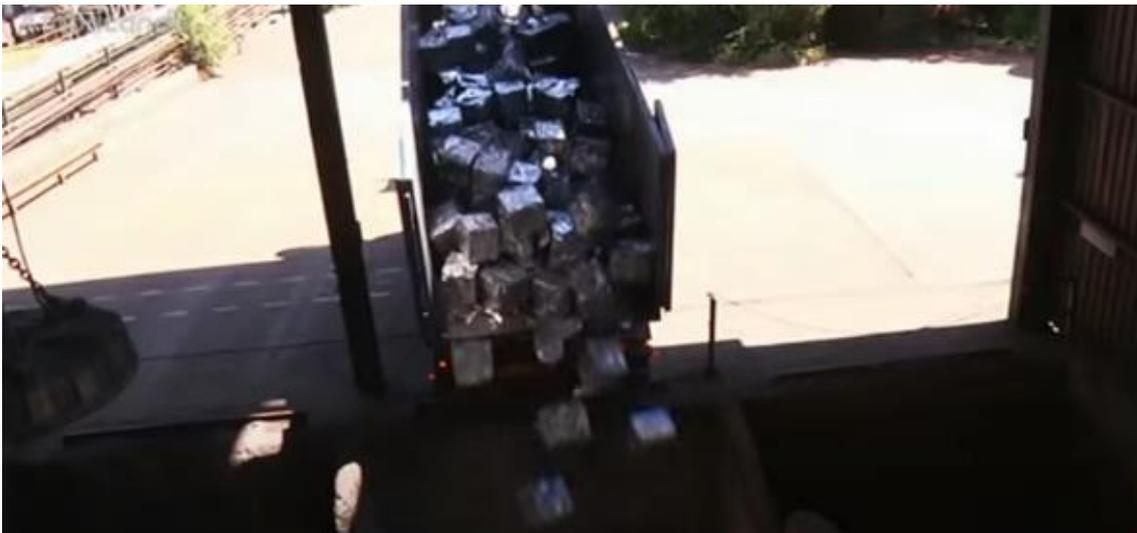
*Figura 3: entrada de chapa reciclada de la industria automotriz y alimentaria reciclada como materia prima para elaborar los discos de freno [3]*
