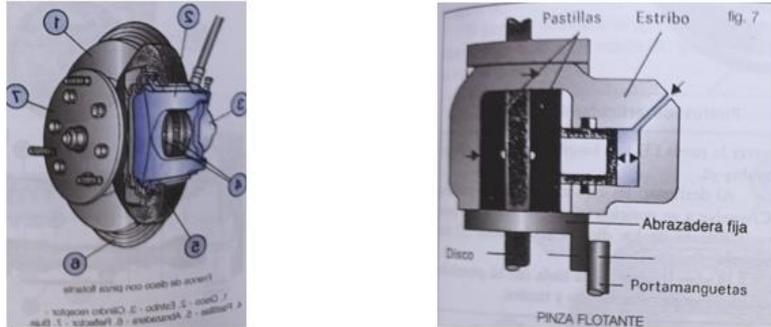
Figura 6: Esquema de frenos con pinza flotante (los más típicos en automoción) [5]
