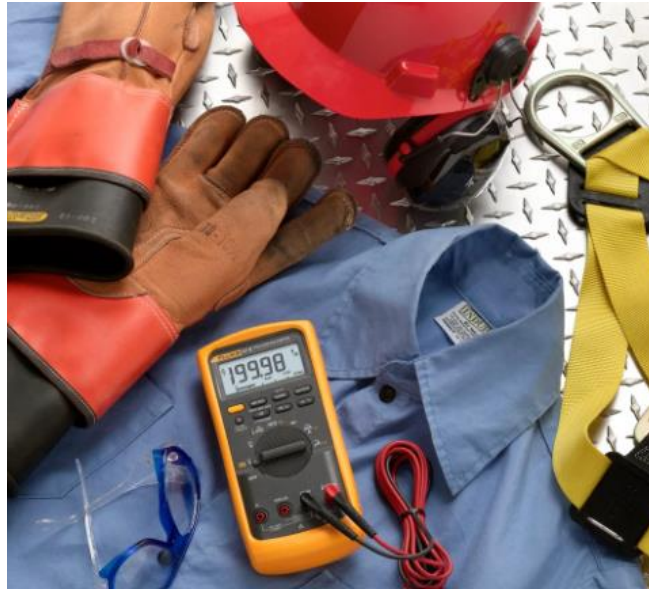
Figura 19: Elementos de protección para la seguridad en el mantenimiento de instalaciones solares fotovoltaicas. Fuente: Buscador de Google.
