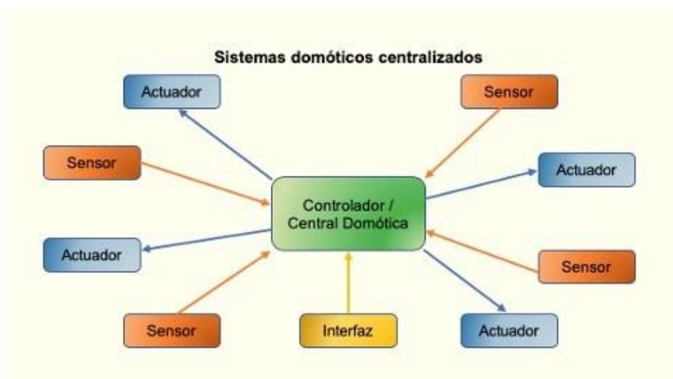
Figura 30. Esquema de sistema domótico centralizado.
