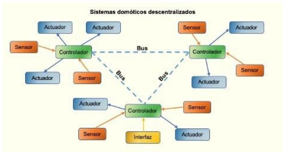
Figura 31. Esquema de sistema domótico descentralizado.
