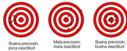
Figura 50. Diferencia entre exactitud y precisión.
