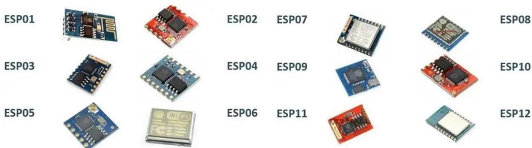
Figura 71. Encapsulados para el ESP8266
