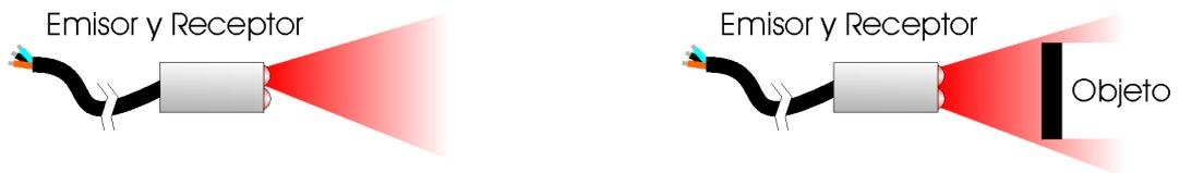
Figura 8. Esquema de funcionamiento de sensor fotoeléctrico autorreflexivo.
