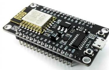
Figura 72. Imagen de la placa NodeMCU v3.
