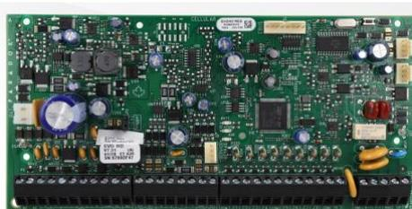
Figura 16. Placa base de la alarma PARADOX.
