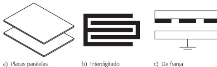
Figura 37. Tipos de condensadores según la configuración de sus terminales.
