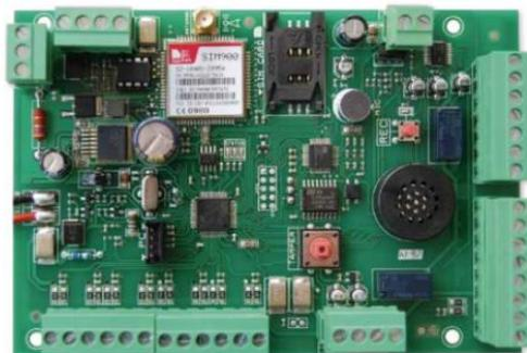
Figura 15. Placa base de la alarma C24GSM/PLUS
