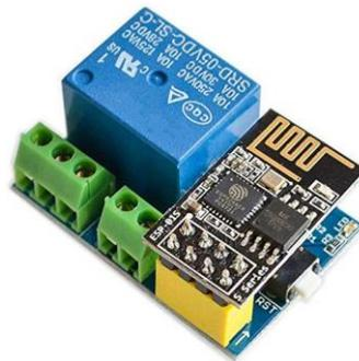
Figura 94. Relé KY-019 con módulo ESP8266-01 para su control.
