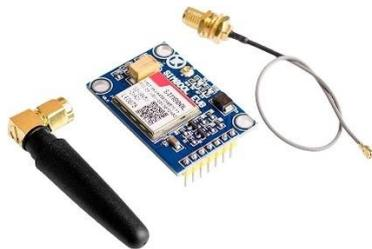
Figura 81. Módulo SIM800L V2.
