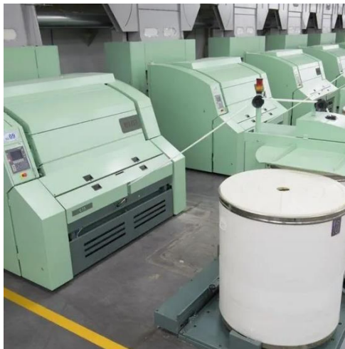
Ilustración 1 : (DirectIndustry,2023) Maquina de cardado.
