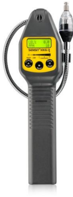
Figura 5. Sensor SENSIT® HXG-3P empleado por Enagás en sus campañas LDAR. Fuente: Vira Gas Imaging
