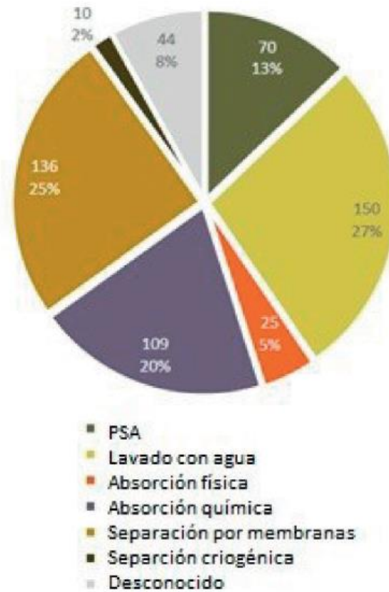
Gráfica 8. Uso de tecnologías de refinado de biogás en toda Europa: Fuente: EBA (European Biogas Association, 2018)
