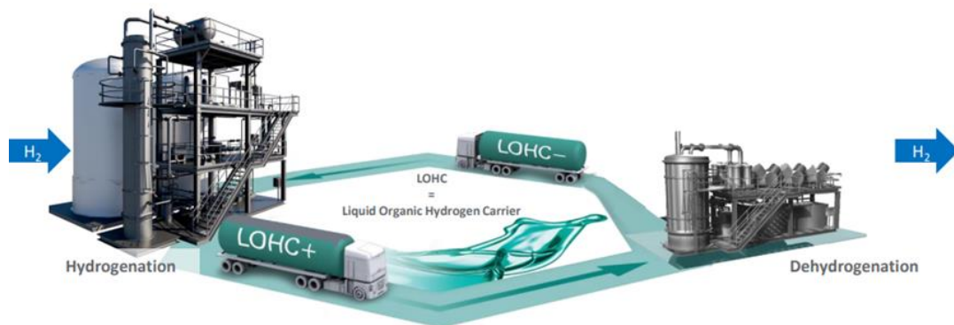
Ilustración 9. Ciclo reversible del transporte de hidrógeno utilizando líquidos orgánicos portadores. Fuente: (Martínez & Teichmann, 2019)
