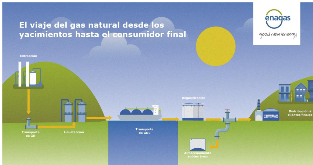
Ilustración 1. Recorrido simplificado que realiza el gas desde su extracción hasta su consumo final. Fuente: Enagás S.A.
