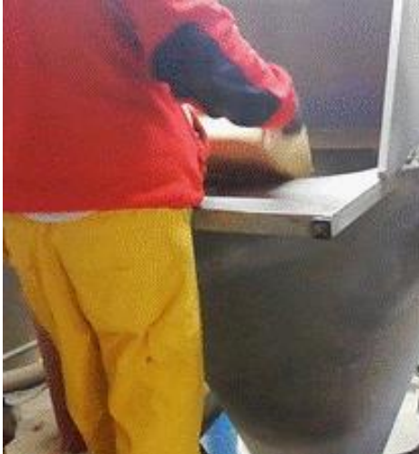
Figura 13. Vaciado de sacos en Tolva
