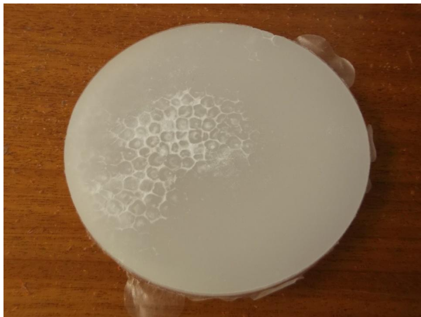
Fig.43. Precursor en el que espumante no se ha dispersado correctamente.
