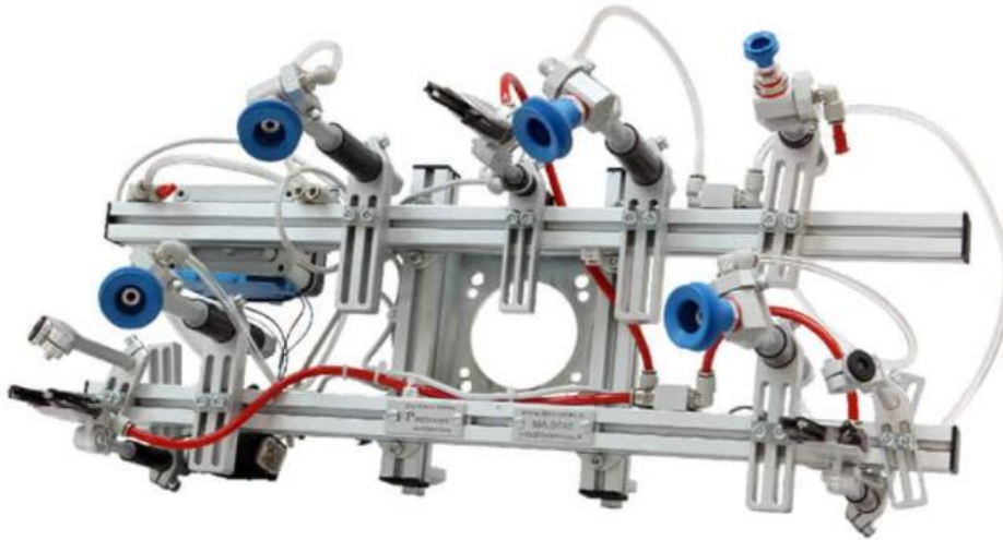
Figura 4: Garra de vacío para extracción de la pieza
