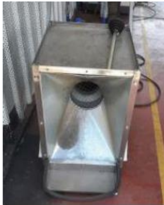
Imagen 4. Extractor Prueba de emisiones de gases (Elaboración Propia)
