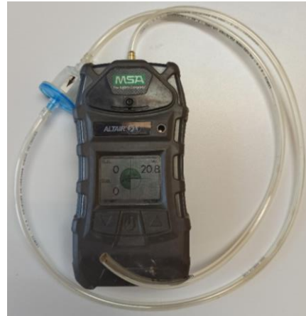
Figura 29: Explosímetro de medida continua
