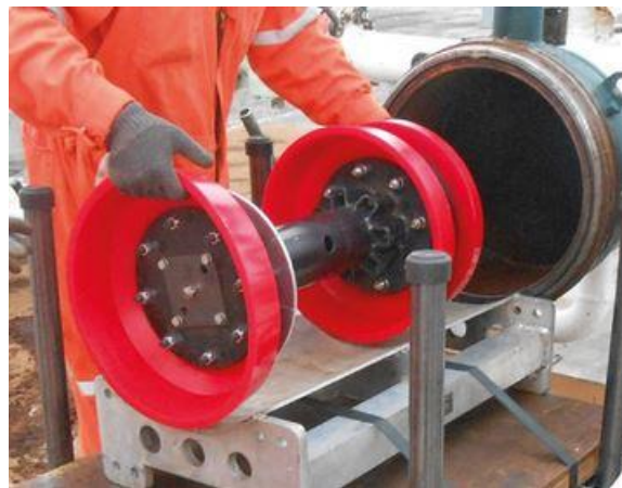
Figura 23: Pistón de limpieza con placa calibrada
