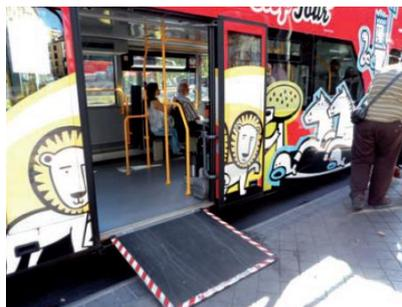
Figura 2.6 Acceso a autobús turístico de piso bajo mediante rampa
