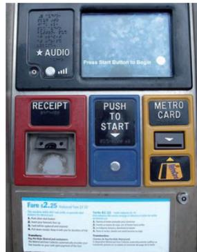
Figura 2.5 Máquina expendedora de billetes con braille y audio
